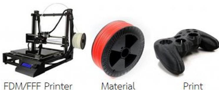
รูปที่ 2.11 ภาพแสดงเครื่องFDM/FFF Printer, Material และ Print [4]
