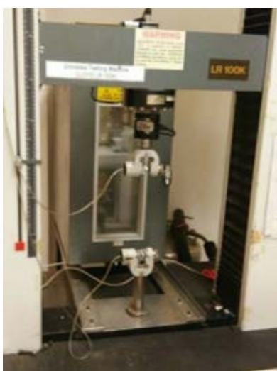
รูปที่ 3.7 รูปตัวอย่างชิ้นทดสอบในรูปดัมเบล ตามมาตรฐาน ASTM D638-14 type V
