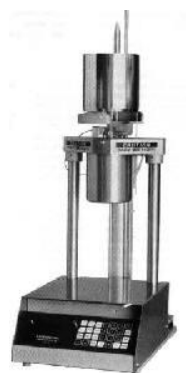
รูปที่ 3.6 เครื่องทดสอบหาค่าดัชนีการหลอมไหลรุ่น 7053
