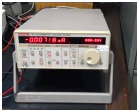
รูปที่ 3.12 เครื่องทดสอบไฟฟ้า (Pico ammeter)
