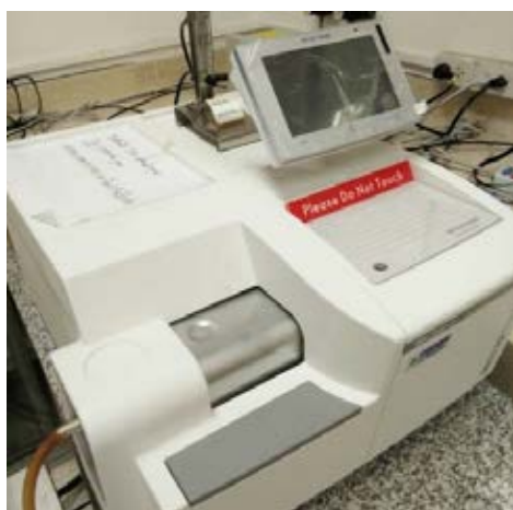
รูปที่ 3.4 เครื่องวิเคราะห์การเปลี่ยนแปลงน้ำหนักของสารโดยอาศัยคุณสมบัติทางความร้อน (TGA)
