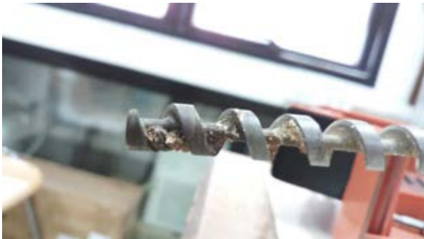
รูปที่ ข.1 ปัญหาที่เกิดจากการอุดตันในการรีดเส้น
