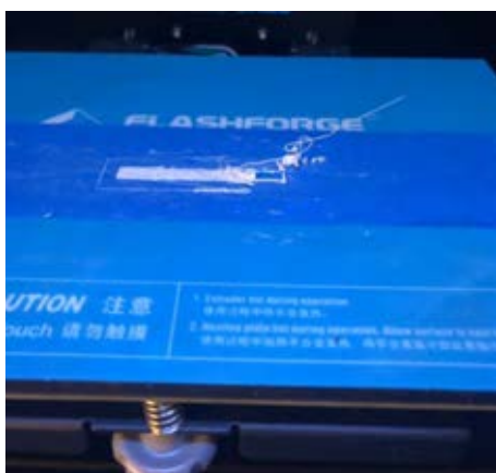
รูปที่ ข.2 ปัญหาที่เกิดจากการอุดตันในการรีดเส้น
