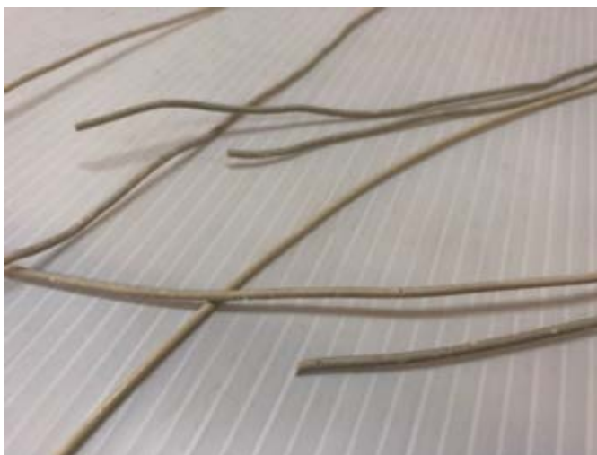
รูปที่ 4.16 ภาพแสดงเส้นที่รีดด้วย สูตร HP11ผสมSilicone oil อุณหภูมิในการรีด 175°C
