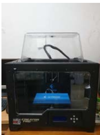
รูปที่ 3.3 เครื่องพิมพ์ 3 มิติ FDM ที่ใช้ในการพิมพ์ชิ้นงาน 3 มิติ
