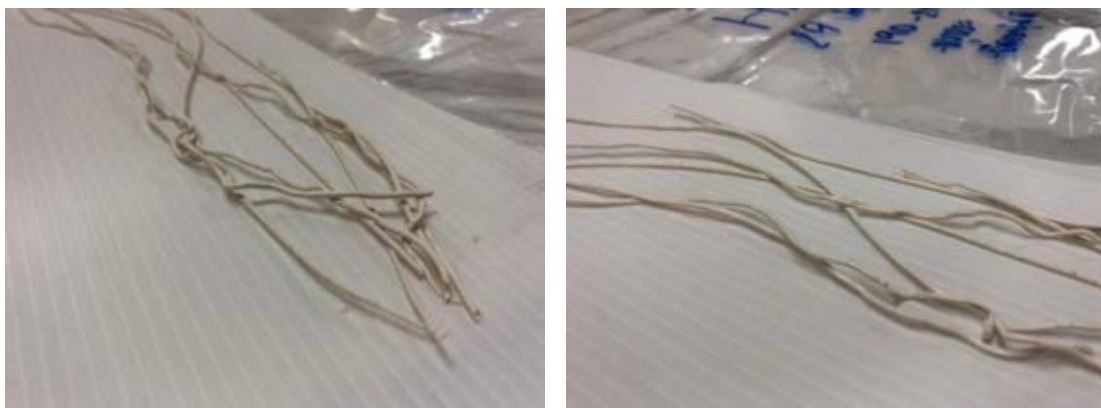
รูปที่ 4.11 ภาพแสดงเส้นที่รีดด้วย สูต HP9 อุณหภูมิในการรีด 190-210 °C
