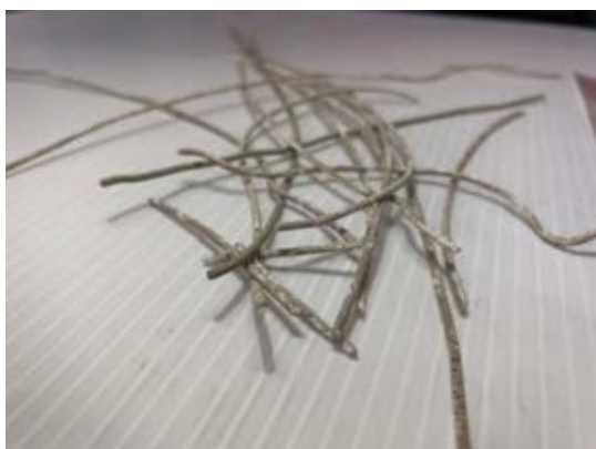
รูปที่ 4.13 ภาพแสดงเส้นที่รีดด้วย สูตร HP11 อุณหภูมิในการรีด 170-180 °C
