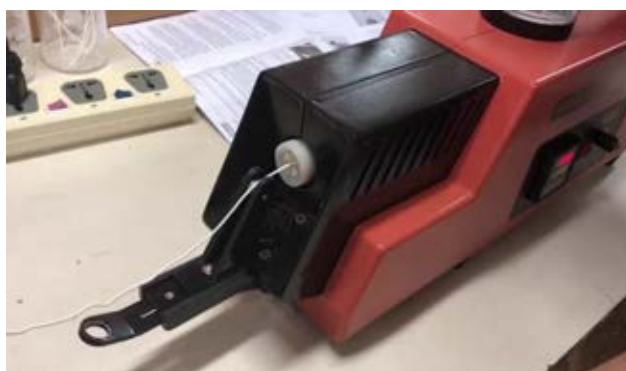
รูปที่ 3.2 แสดงลักษณะการรีดเส้นใยผ่านเครื่องรีดร้อน
