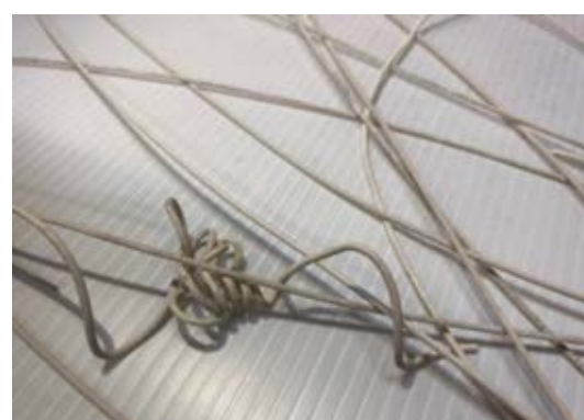
รูปที่ 4.14 ภาพแสดงเส้นที่รีดด้วย สูตร HP11 อุณหภูมิในการรีด 175 °C
