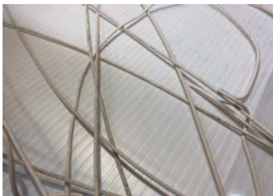
รูปที่ 4.14 ภาพแสดงเส้นที่รีดด้วย สูตร HP11 อุณหภูมิในการรีด 175 °C
