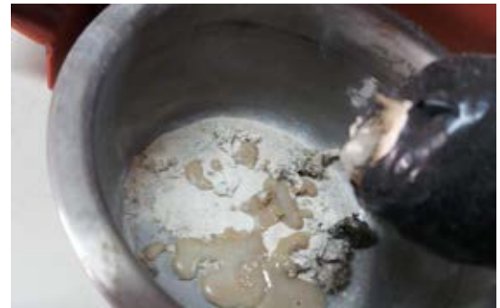
รูปที่ ข.1 ปัญหาที่เกิดจากการอุดตันในการรีดเส้น
