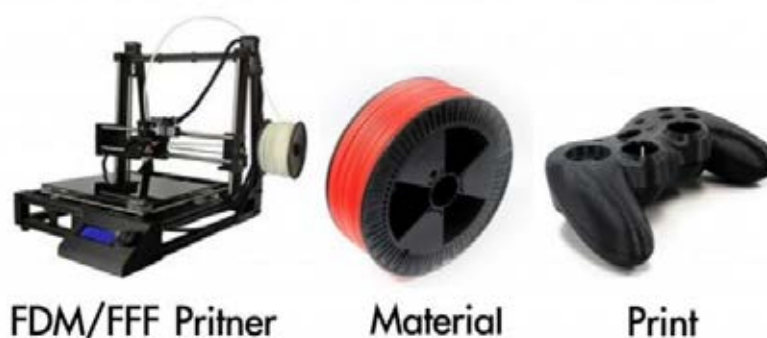
รูปที่ 2.3 ตัวอย่างเครื่องพิมพ์ 3 มิติ เส้นวัสดุพลาสติกสำหรับฉีด และชิ้นงานตัวอย่างที่พิมพ์ออกมา
