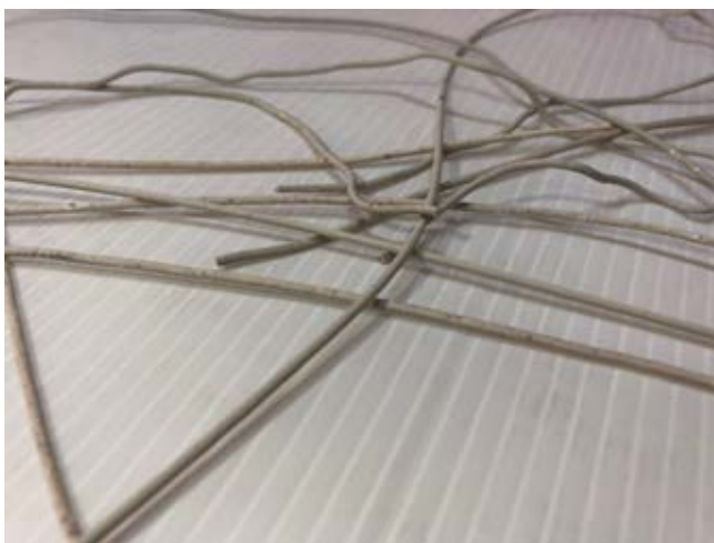
รูปที่ 4.15 ภาพแสดงเส้นที่รีดด้วย สูตร HP11 อุณหภูมิในการรีด 175°C
