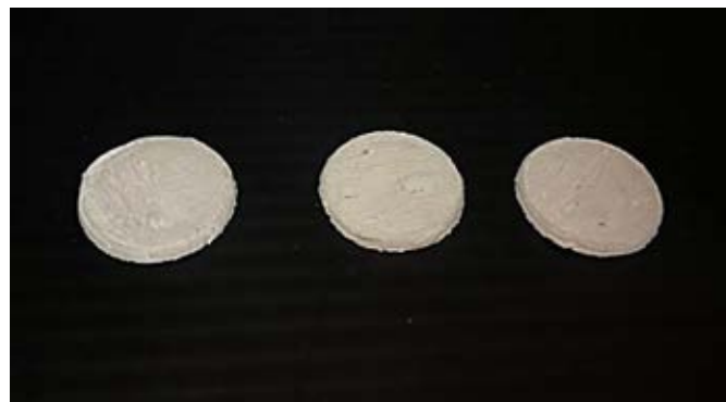
รูปที่ 4.26 ภาพชิ้นงาน 3 มิติทรงเหรียญหลังอบ
