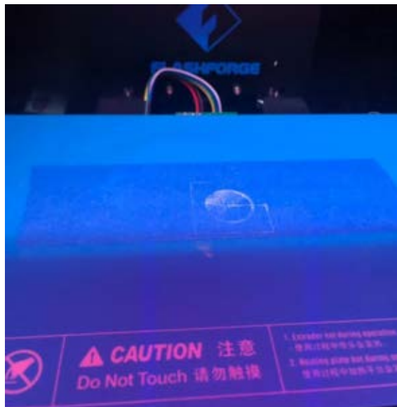
รูปที่ 4.20 ภาพแสดงเส้นใยไม่สามารถพิมพ์เป็นชิ้นงาน 3 มิติได้
