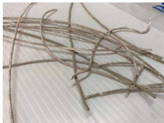
รูปที่ 4.13 ภาพแสดงเส้นที่รีดด้วย สูตร HP11 อุณหภูมิในการรีด 170-180 °C
