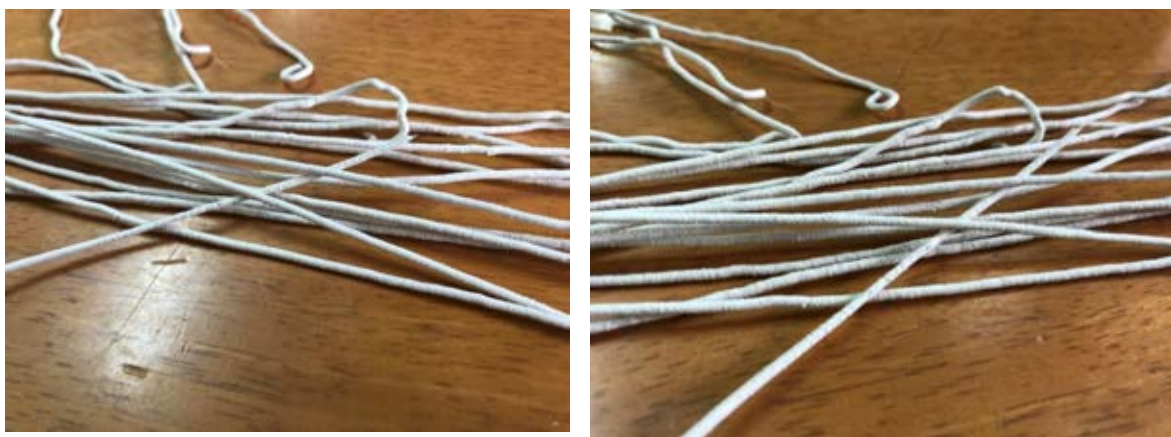
รูปที่ 4.17 เมื่อรีดด้วยเครื่อง extrusion ที่อุณหภูมิ 220 °C
