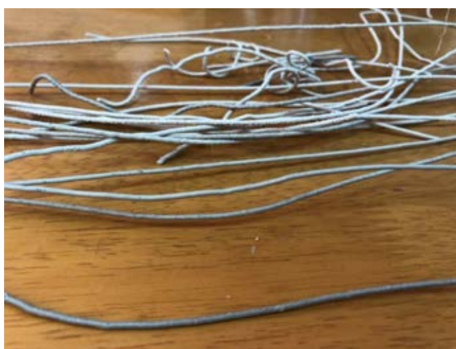
รูปที่ 4.18 เมื่อรีดซ้ำด้วยเครื่องรีดเส้น ที่อุณหภูมิ 180 °C
