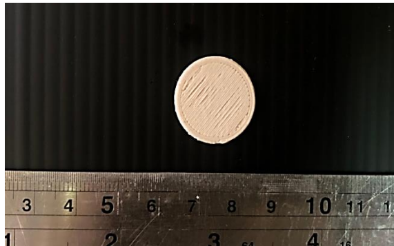
รูปที่ 4.22 ภาพชิ้นงาน 3 มิติทรงเหรียญที่พิมพ์ได้โดยใช้สูตร HP13
