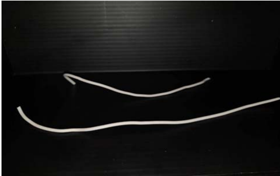
รูปที่ 4.19 เส้นที่ได้จากการผสมเปียกสูตร HP13
