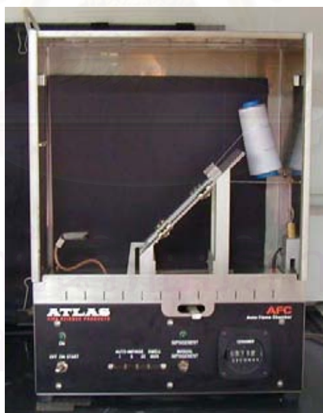
รูปที่ 3.6 เครื่องทดสอบความสามารถในการลุกลามของเปลวไฟในแนว 45 องศา (Atlas 45 0 Automatic Flammability Tester)
