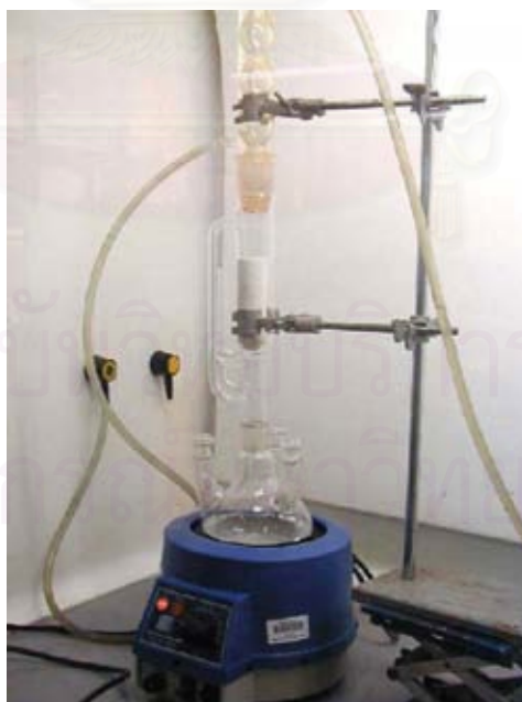
รูปที่ 3.3 การสกัดไขมันออกจากขนไก่ด้วยวิธี Soxhlet extraction
