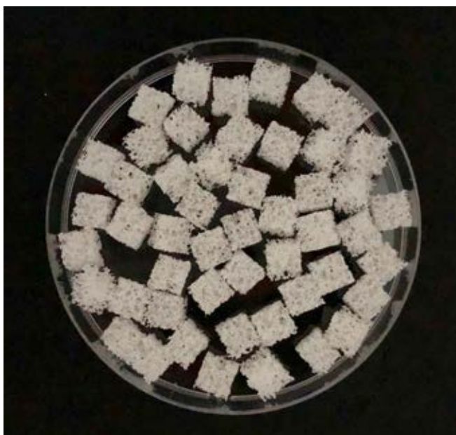
รูปที่ 3.3 Aquaporousgel ที่ใช้เป็นวัสดุสำหรับตรึงเซลล์ในการผลิตสารลดแรงตึงผิวชีวภาพ
