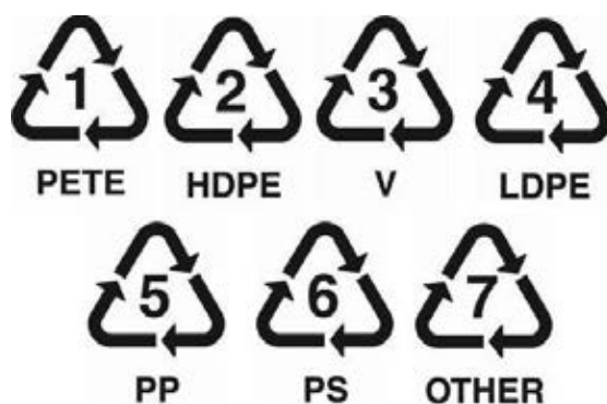
รูปที่ 1 สัญลักษณ์ที่แสดงถึงพลาสติกแต่ละชนิด ตามตัวเลขที่สามารถนำมารีไซเคิลได้
