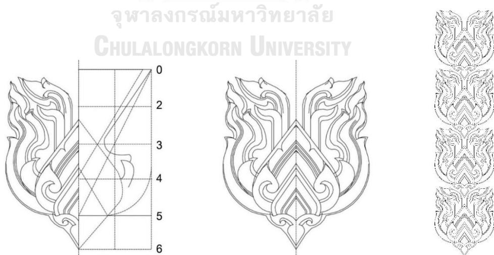
ภาพที่ 92 แสดงลายกระจัดและการต่อลายของแผงกั้นคอนกรีตในโบสถ์วัดบ้านเซเวียร์
