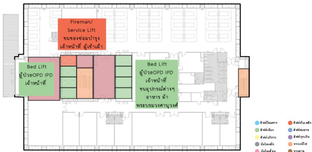
ภาพที่ 4-88 ภาพแสดงผังการใช้ลิฟต์ของอาคาร A5
