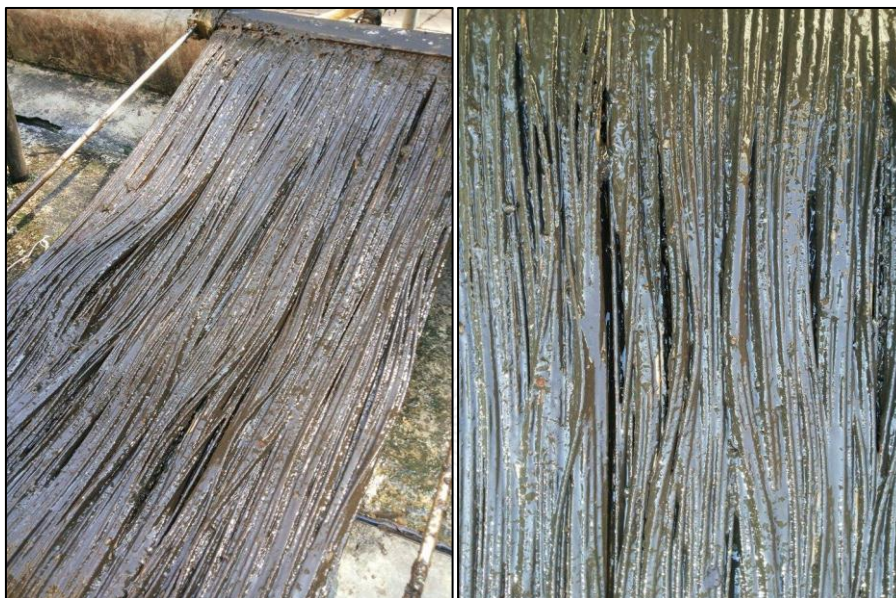
รูปที่ ข-1 ลักษณะเมมเบรนที่เกิดการอุดตันในส่วนเติมอากาศของถังปฏิกรณ์ชีวภาพเมมเบรนแบบ คลองวนเวียน
