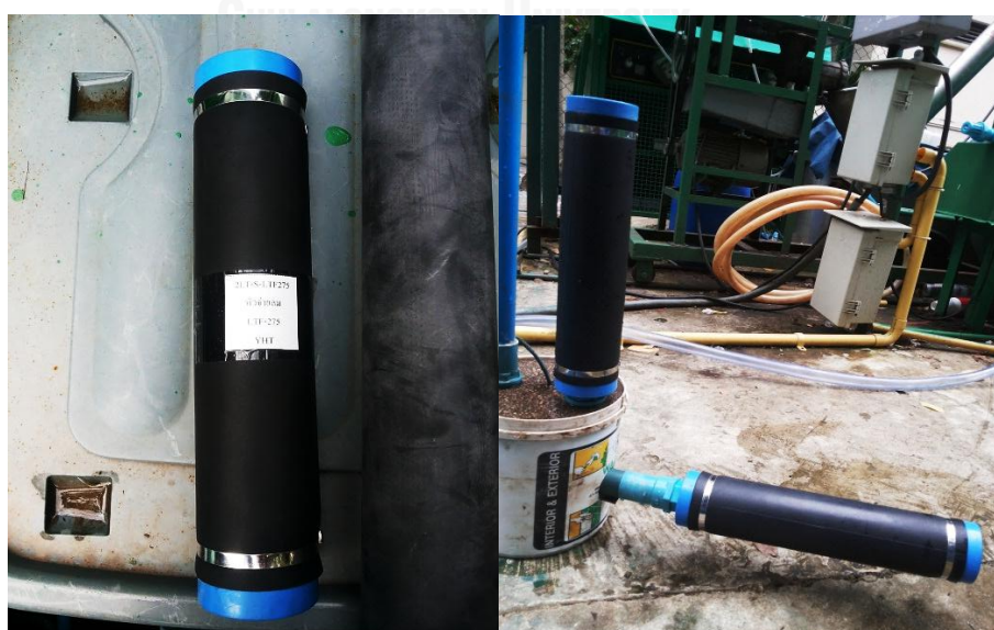
รูปที่ 16 หัวฟู่กระจายอากาศ (Tube Diffuser)
