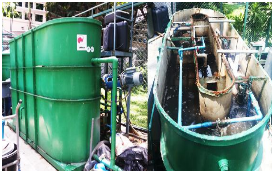
รูปที่ 11 ถังปฏิกรณ์ชีวภาพเมมเบรนแบบคลองวนเวียน
