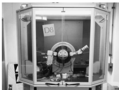
รูปที่ 3.7 เครื่อง Wide Angle X-ray Diffractometer ของ BRUKER รุ่น AXS Diffraktometer
