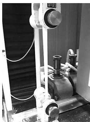
รูปที่ 3.5 การดึงยืดฟิล์มเป่าพอลิโพรพิลีนคอมโพสิต ด้วยเครื่อง Universal testing machine ของ LLOYD รุ่น LR100K
