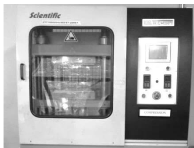
รูปที่ 3.3 เครื่อง Compression moulding ของ Lab tech รุ่น V508-18-CX
