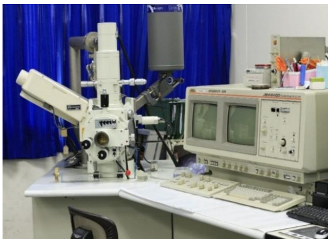
รูปที่ 3. 3 กล้องจุลทรรศน์อิเล็กตรอนแบบส่องกราด
