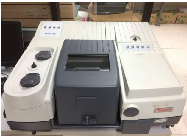
รูปที่ 3. 2 เครื่องฟูเรียร์ทรานส์ฟอร์มอินฟราเรดสเปกโทรมิเตอร์
