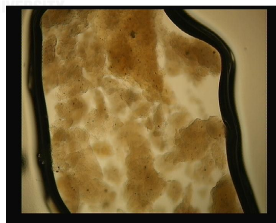
(d) Acetylated chitosan whisker X4
