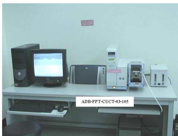
รูปที่ 3.8 เครื่อง TG/DTA ยี่ห้อ PerkinElmer รุ่น Pyris Diamond model.
