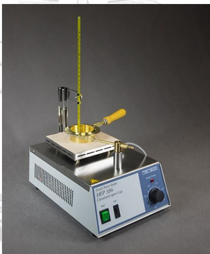
รูปที่ จ.2 อุปกรณ์การทดสอบจุดวาบไฟและจุดติดไฟ
