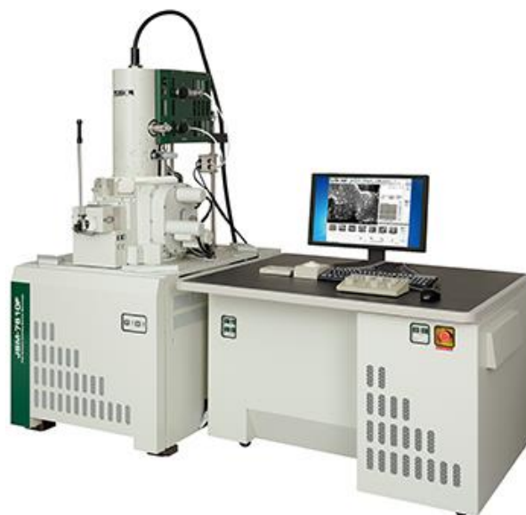
รูปที่ 3.5 กล้องจุลทรรศน์อิเล็กตรอนแบบส่องกราดและอุปกรณ์วิเคราะห์ธาตุ รุ่น JSM-6480LV และ INCAx-sight
