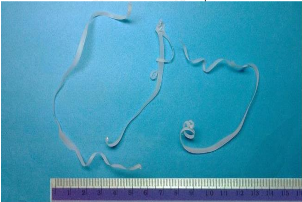
อัตราป้อนตัด 1.5 ความเร็วตัด 2,392 รอบต่อนาที มุมคายเศษ 0 องศา
