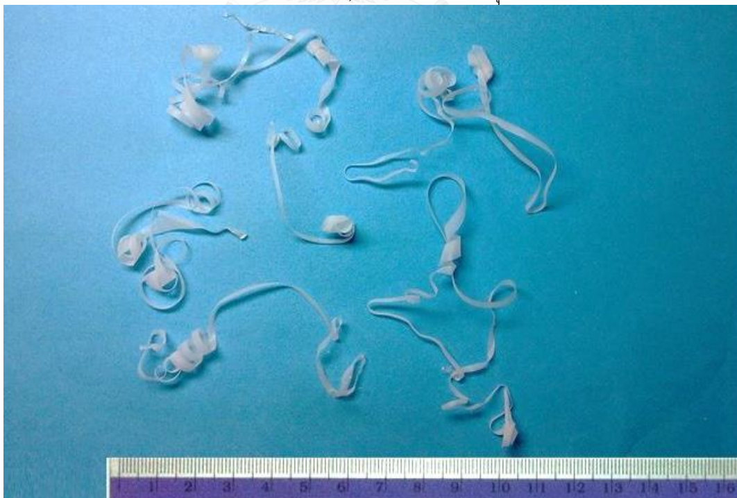
อัตราป้อนตัด 1.0 ความเร็วตัด 4,185 รอบต่อนาที มุมคายเศษ 0 องศา
