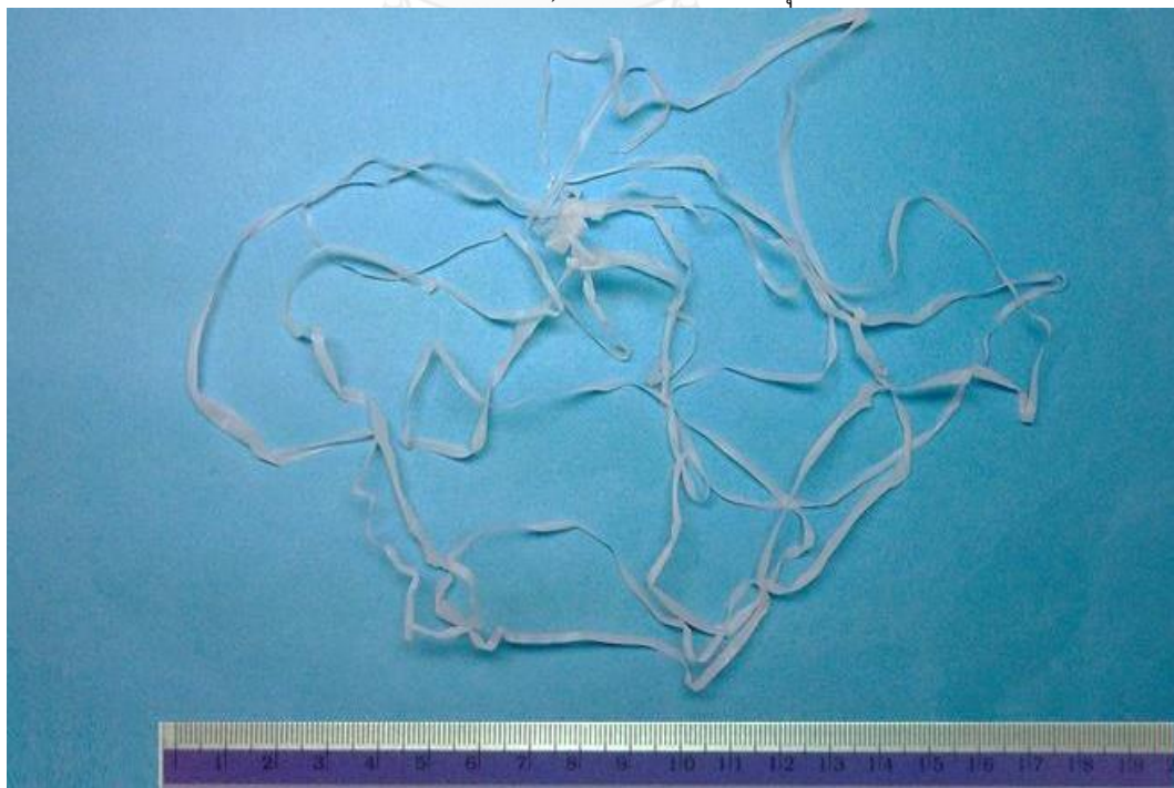
อัตราป้อนตัด 1.5 ความเร็วตัด 4,185 รอบต่อนาที มุมคายเศษ 10 องศา
