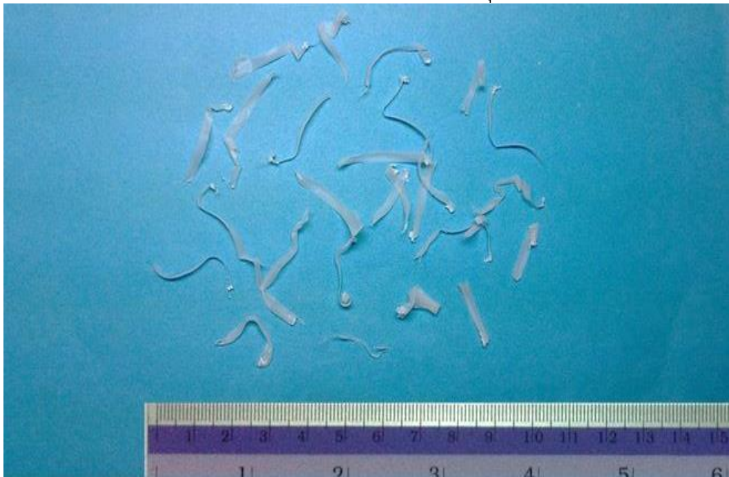
อัตราป้อนตัด 1.0 ความเร็วตัด 4,780 รอบต่อนาที มุมคายเศษ 20 องศา
