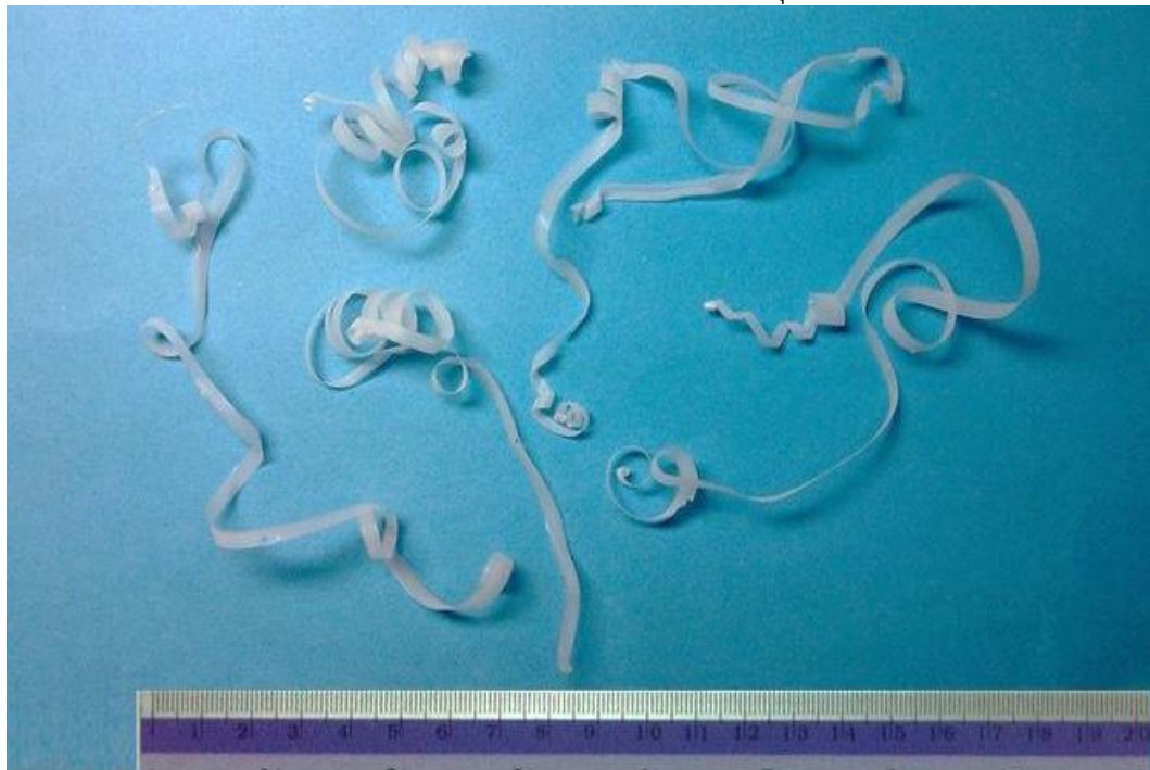
อัตราป้อนตัด 1.5 ความเร็วตัด 4,185 รอบต่อนาที มุมคายเศษ 0 องศา
