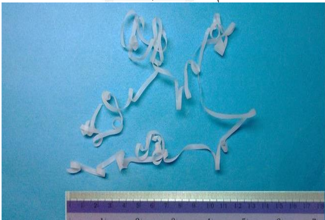
อัตราป้อนตัด 2.0 ความเร็วตัด 2,392 รอบต่อนาที มุมคายเศษ 10 องศา
