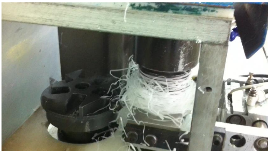
รูปที่ 4 เศษเลนส์พันรอบตัวจับเลนส์และเลนส์ในขณะที่ตัดขอบเลนส์
