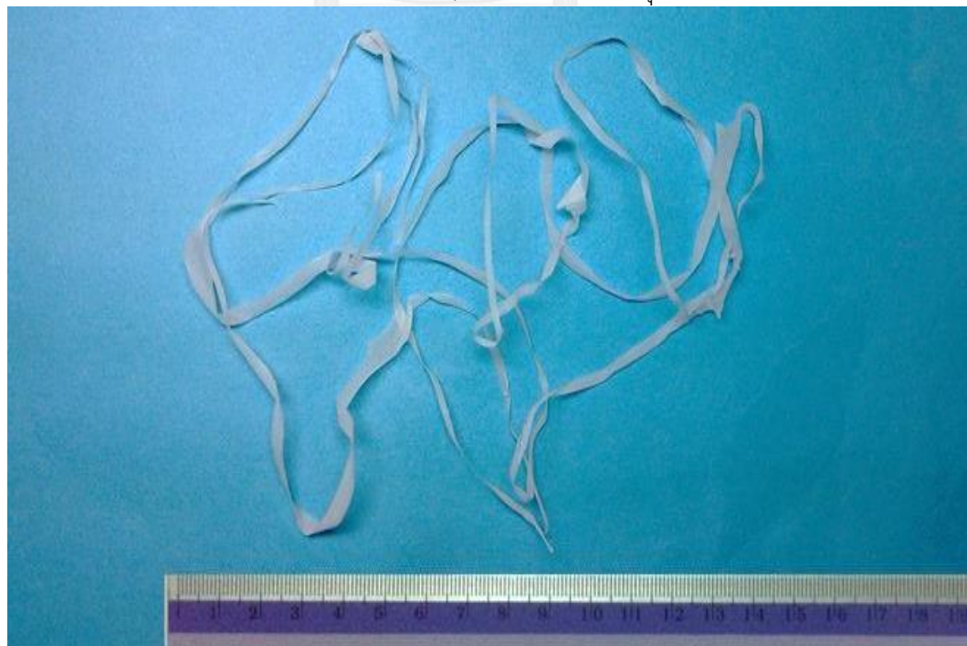
อัตราป้อนตัด 2.0 ความเร็วตัด 2,990 รอบต่อนาที มุมคายเศษ 20 องศา
