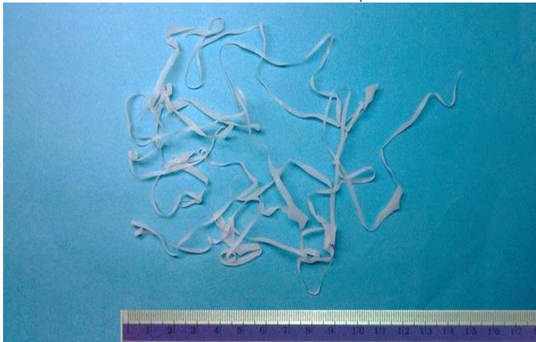
อัตราป้อนตัด 2.0 ความเร็วตัด 2,990 รอบต่อนาที มุมคายเศษ 10 องศา
