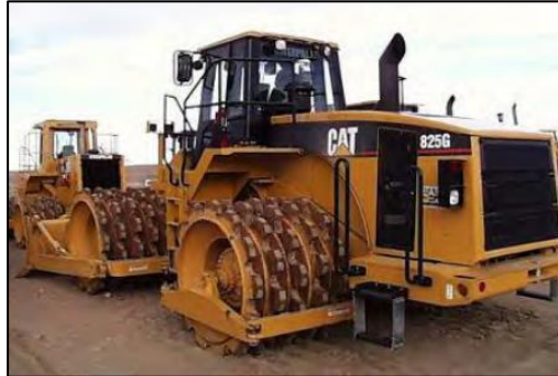
ภาพที่ 4. 11 รถบดล้อหนามขนาดใหญ่ใช้สำหรับบดอัดดิน (กรมชลประทาน, 2557)
