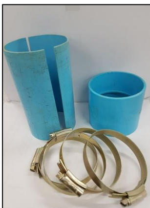
ภาพที่ 3. 5 ชุดอุปกรณ์ขึ้นรูปตัวอย่างทดสอบ
