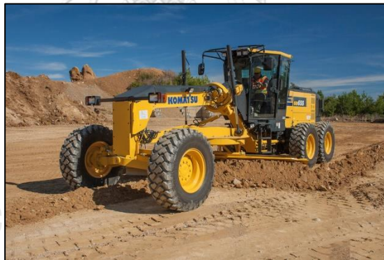
ภาพที่ 4. 12 รถปาดเกลี่ยใช้ปาดหน้าดินในหลุมฝังกลบขยะให้เรียบ (Equipmentworld, 2016)
