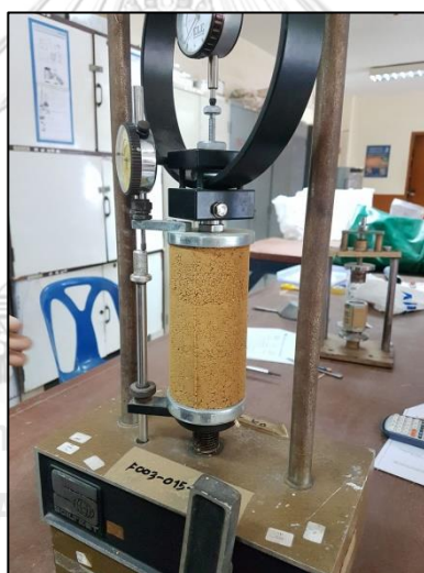
ภาพที่ ก. 3 การวางตัวอย่างดินบนแท่นทดสอบ
