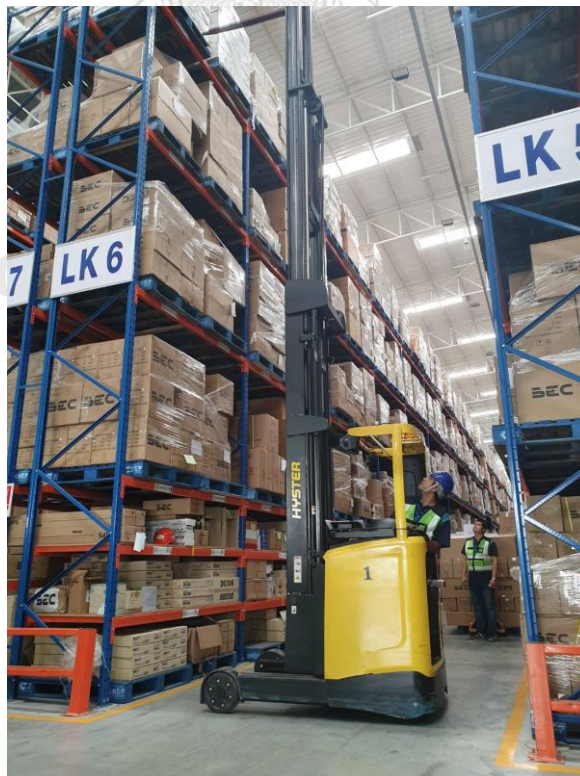
รูปที่ 3.5 พาเลทแร็คแบบลึก 1 พาเลทและรถฟอล์คลิฟท์ของศูนย์กระจายสินค้ากรณีศึกษา
