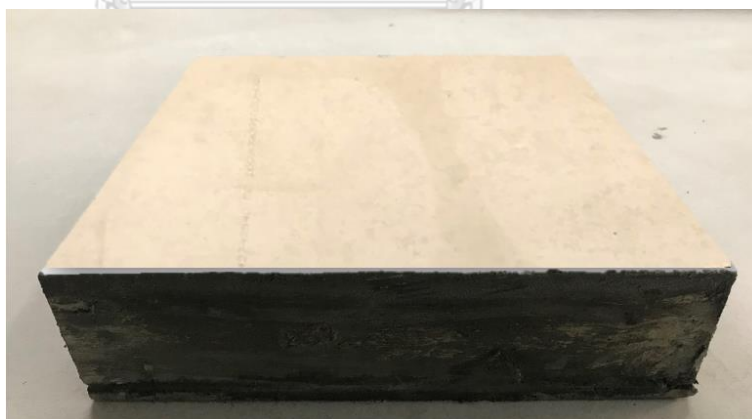
รูปที่ 4-35 ตัวอย่างทดสอบคอนกรีตความหนาแน่นต่ำมาก ปิดผิวตัวอย่างด้วยซีเมนต์บอร์ด
