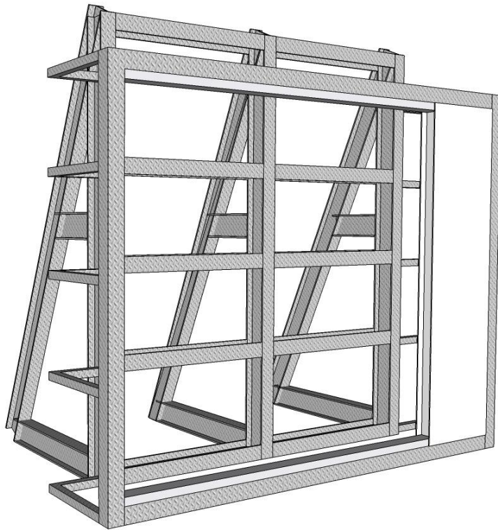
รูปที่ 3-13 การติดตั้งแผ่นผนัง โดยแผ่นผนังสามารถสไลด์บนรางได้
