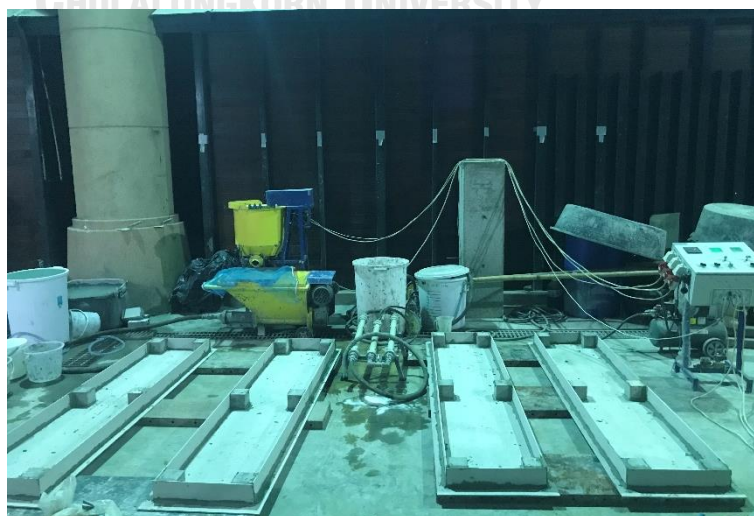
รูปที่ 4-15 เตรียมอุปกรณ์เพื่อกรอกคอนกรีตความหนาแน่นต่ำมาก
