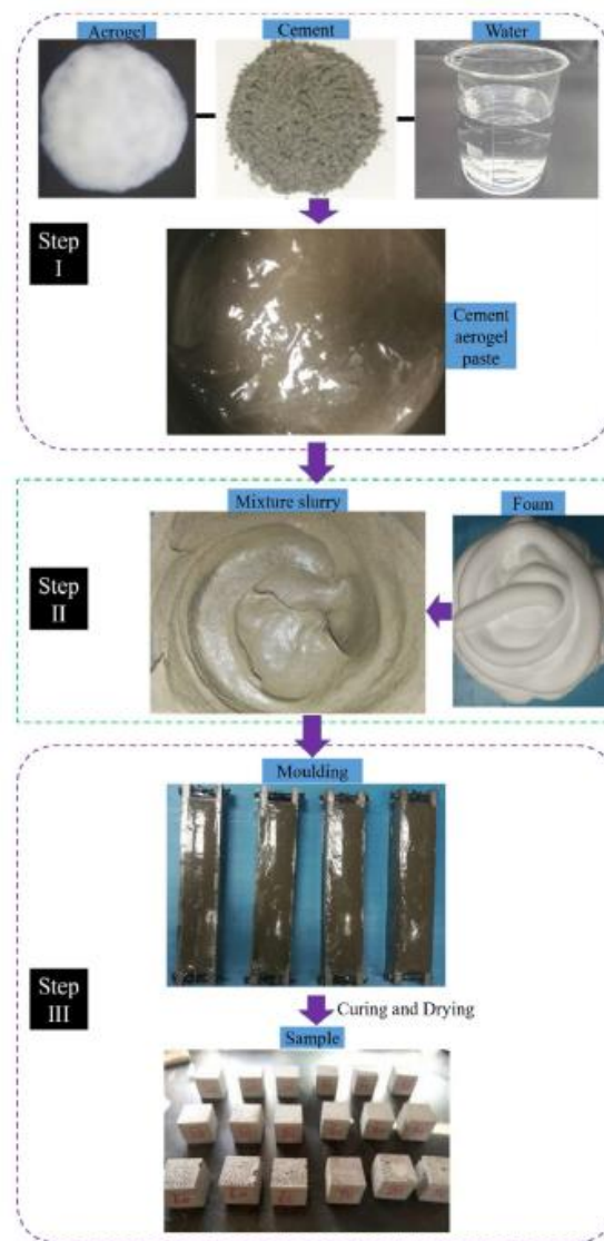
รูปที่ 2-9 ขั้นตอนการเตรียมคอนกรีตโฟม (Li และคณะ, 2019)
