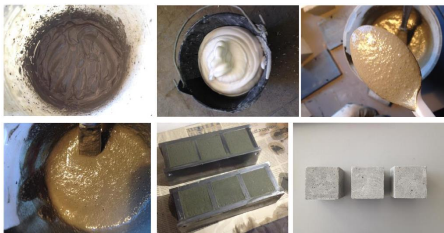
รูปที่ 2-10 การเตรียมคอนกรีตและระยะการหล่อในรูปทรงลูกบาศก์ (Falliano และคณะ, 2018)
