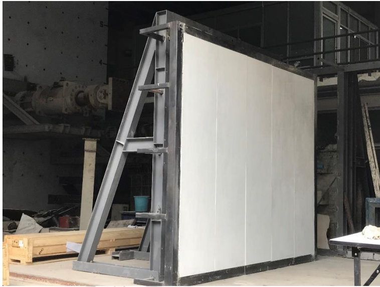
รูปที่ 3-15 ผนังทดสอบที่ติดตั้งแล้วเสร็จ
