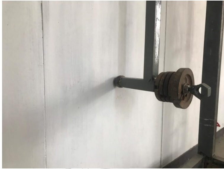
รูปที่ 4-20 อุปกรณ์ทดสอบความสามารถของผนังในการรับแรงกระแทกด้วยวัสดุแข็งขนาดเล็ก
