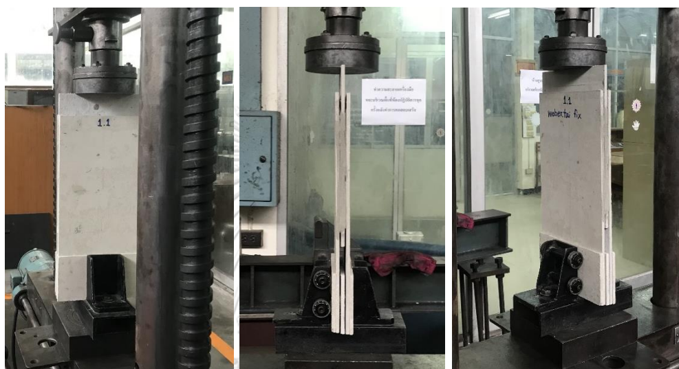
รูปที่ 4-2 ตัวอย่างทดสอบกำลังรับแรงเฉือน
