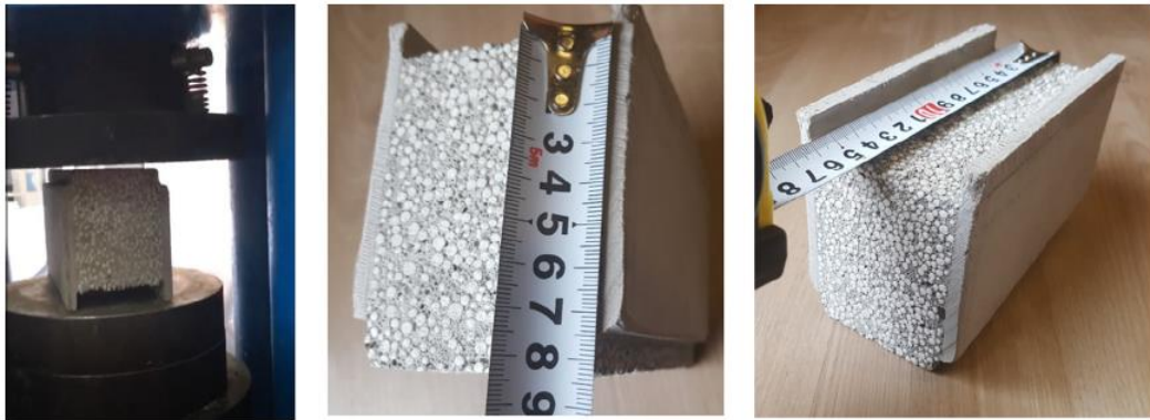
รูปที่ 3-5 การเตรียมการทดสอบการยึดเกาะระหว่าง CSB กับ LWC (Assaad et al., 2018)
