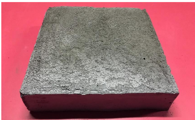
รูปที่ 4-34 ตัวอย่างทดสอบคอนกรีตความหนาแน่นต่ำมาก ที่เป็นเนื้อเดียว ไม่มีการปิดผิวตัวอย่าง
