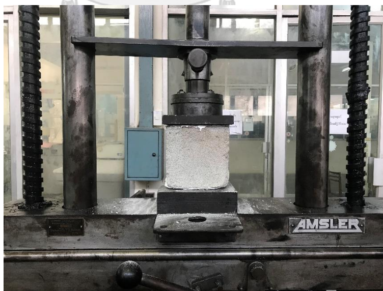
รูปที่ 3-4 ตัวอย่างทดสอบกำลังอัดคอนกรีตความหนาแน่นต่ำมาก
