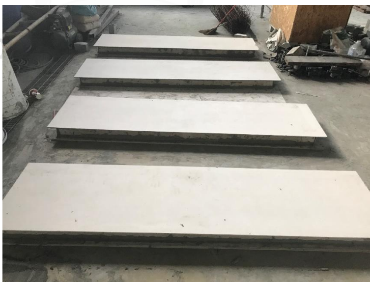
รูปที่ 4-17 แผ่นผนังฉนวนสำเร็จรูปแกนคอนกรีตความหนาแน่นต่ำมาก ที่ทำการประกอบแล้วเสร็จ
