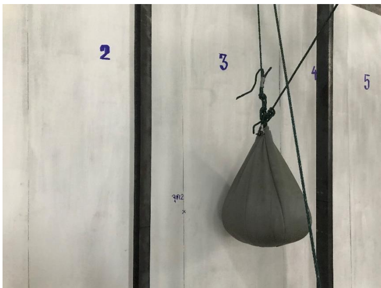
รูปที่ 4-23 อุปกรณ์ทดสอบความสามารถของผนังในการรับแรงกระแทกด้วยวัสดุอ่อนนุ่มขนาดใหญ่ ที่ตำแหน่งทดสอบที่ 1
