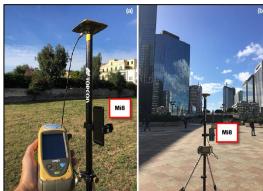
รูปที่ 10 ลักษณะของการวางสมาร์ทโฟน Mi8 ขณะรังวัดสัญญาณฯ พื้นโล่ง (a) และพื้นปกคลุมด้วยอาคาร (b)
