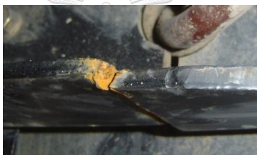
ภาพที่ 19 ลักษณะความเสียหายของแชสซีในจุดหยุดเชื่อมไม่เต็มแนว
