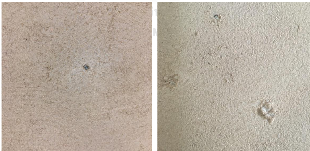
รูปที่ 3.9 ลักษณะของกระเบื้องผิวหน้าไม่เรียบ (Rough Surface)
