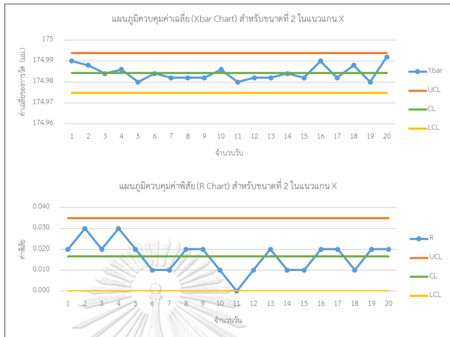
รูปที่ 4.6 แผนภูมิควบคุมค่าเฉลี่ยและค่าพิสัย สำหรับขนาดที่ 2 ในแนวแกน X
