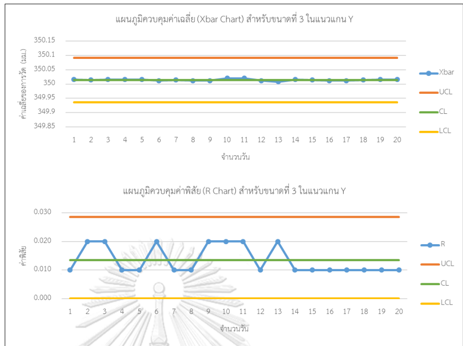
รูปที่ 4.12 แผนภูมิควบคุมค่าเฉลี่ยและค่าพิสัย สำหรับขนาดที่ 3 ในแนวแกน Y
