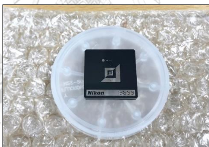
รูปที่ 4.3 แผ่นสอบเทียบ Nikon Glass gauge ของเครื่องมือวัด Nikon NEXIV VMZ-R6555
