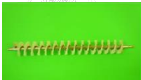
รูปที่ 7.2 แปรงทำความสะอาดหน้าแม่พิมพ์ใหม่ที่นำมาเปลี่ยนแทนแปรงเก่าในกรณีอายุงานครบ 3 เดือน หรือแปรงมีสภาพผิดปกติ หรือ ชำรุด
