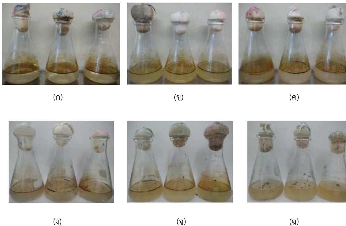
รูปที่ 4.1 การเปลี่ยนแปลงลักษณะของอาหารเลี้ยงเชื้อ NSM ที่มีน้ำมันดิบความเข้มข้น 2,000 มิลลิกรัมต่อลิตร ชุดควบคุม วันที่ 0 (ก), ชุดทดลองที่มี Sphingobium sp. MO2-4 วันที่ 0 (ข), ชุดทดลองที่มี B. megaterium TL01-2 วันที่ 0 (ค), ชุดควบคุม วันที่ 7 (ง), ชุดทดลองที่มี Sphingobium sp. MO2-4 วันที่ 7 (จ) และชุดทดลองที่มี B. megaterium TL01-2 วันที่ 7 (ฉ)
