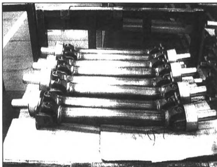
รูปที่ 5.10 แสดงชิ้นงานเพลากลางสำเร็จรูปรอเข้าทดสอบค่าสมดุล
