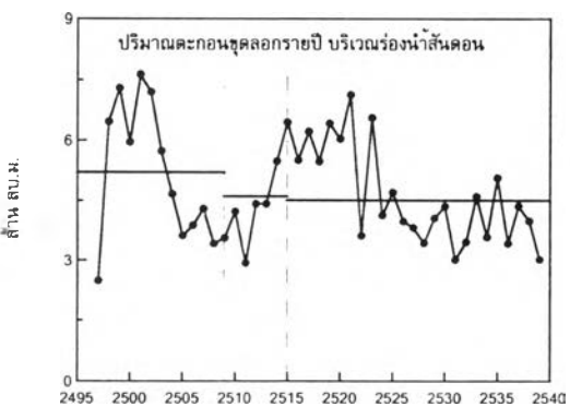
รูปที่ 5-8 เปรียบเทียบข้อมูลการเปลี่ยนแปลงชายฝั่ง ปริมาณตะกอนแขวนลอย และปริมาณตะกอนขุดลอก
