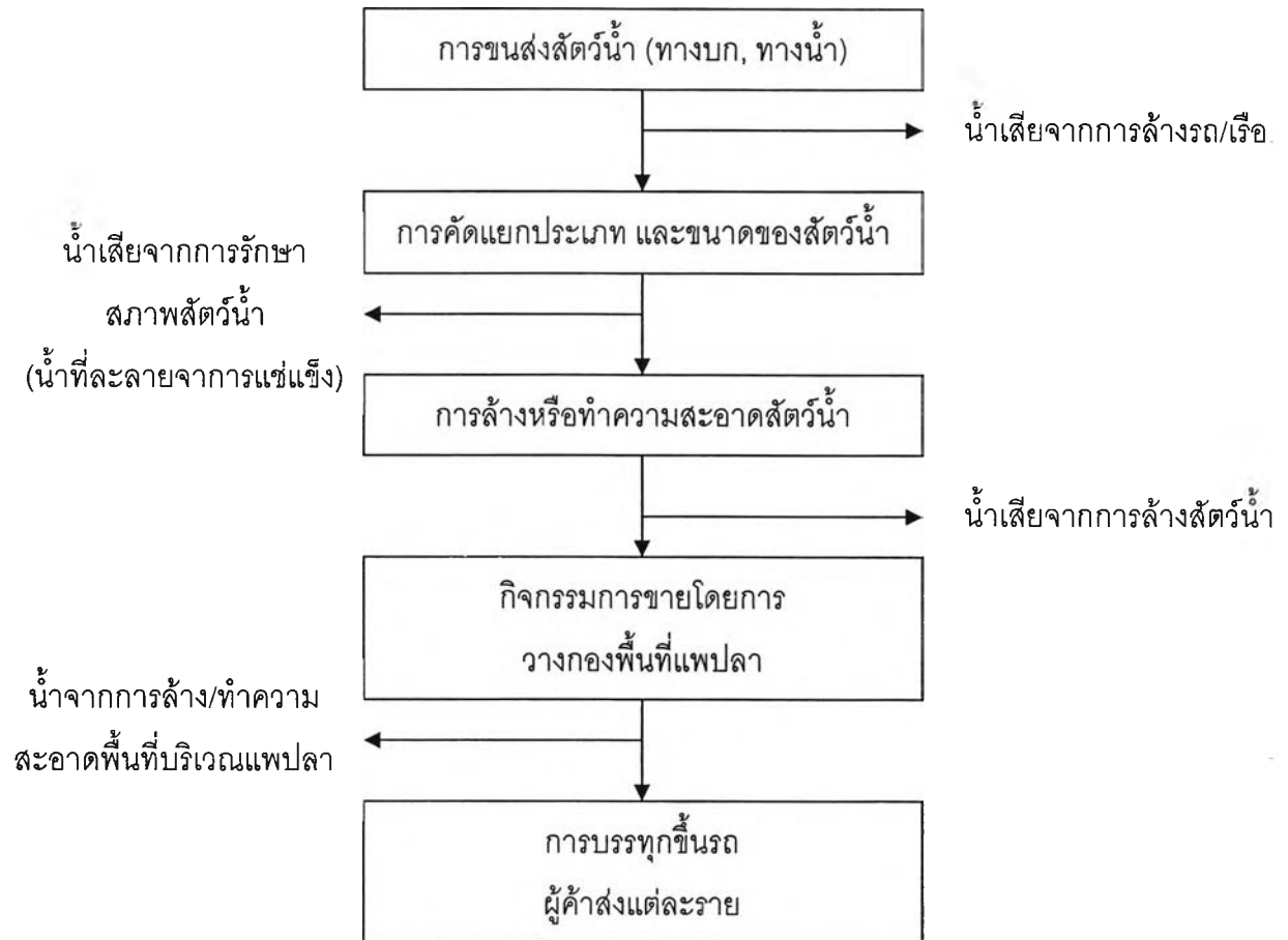
รูปที่ 2.17 กิจกรรมและการเกิดน้ำเสียจากกิจกรรมภายในพื้นที่ท่าเทียบเรือประมง, สะพานปลา และแพปลา (กรมควบคุมมลพิษ, 2544)
