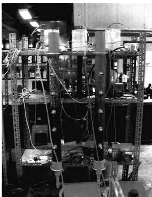
รูปที่ 3.5 การติดตั้งถังกรองชีวภาพ
