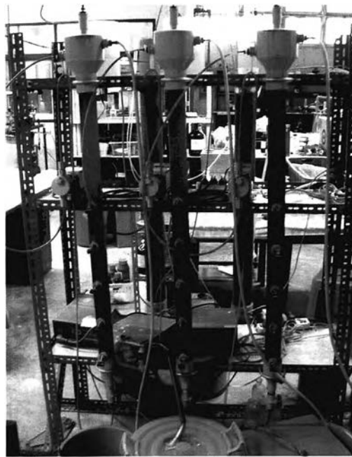
รูปที่ 3.4 การติดตั้งถังปฏิกรณ์อิจิเอสบี
