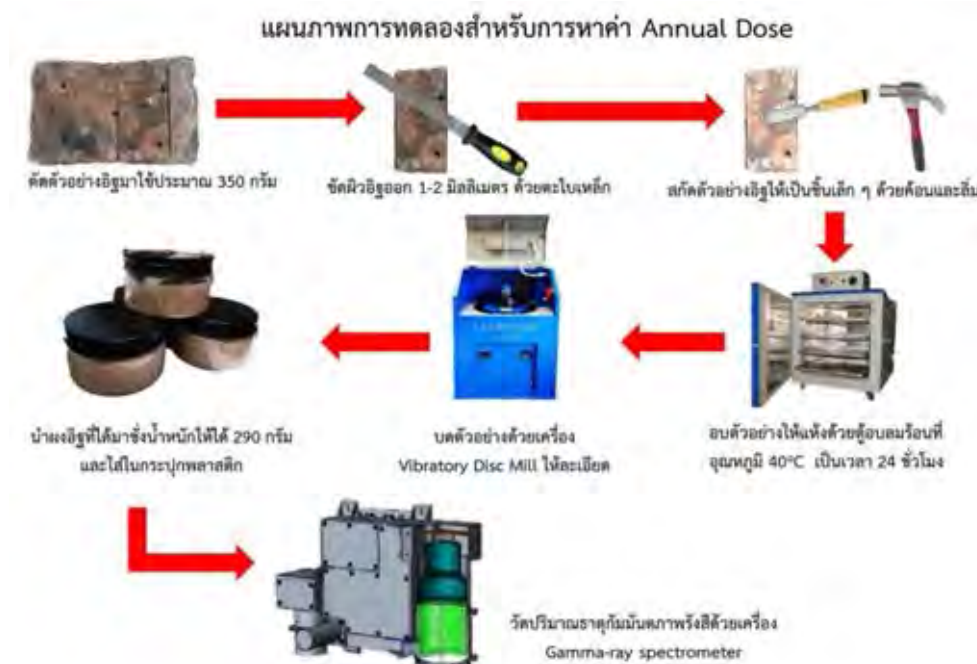
รูปที่ 16 รูปแสดงแผนภาพการทดลองสำหรับการหาค่า Annual Dose
