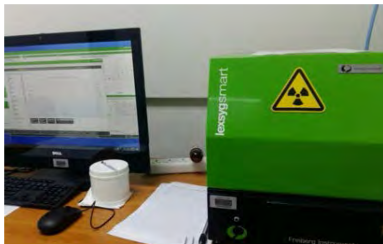
รูปที่ 19 รูปแสดงเครื่อง Lexysmart-Automated TL/OSL Reader ของสถาบันเทคโนโลยีนิวเคลียร์แห่งชาติ (องค์การมหาชน)
