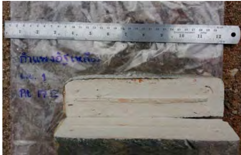
รูปที่ 14 รูปแสดงลักษณะทางกายภาพภายใน (สี) ของตัวอย่างอิฐ SK2-1 ที่สังเกตได้จากการตัดทดสอบ
