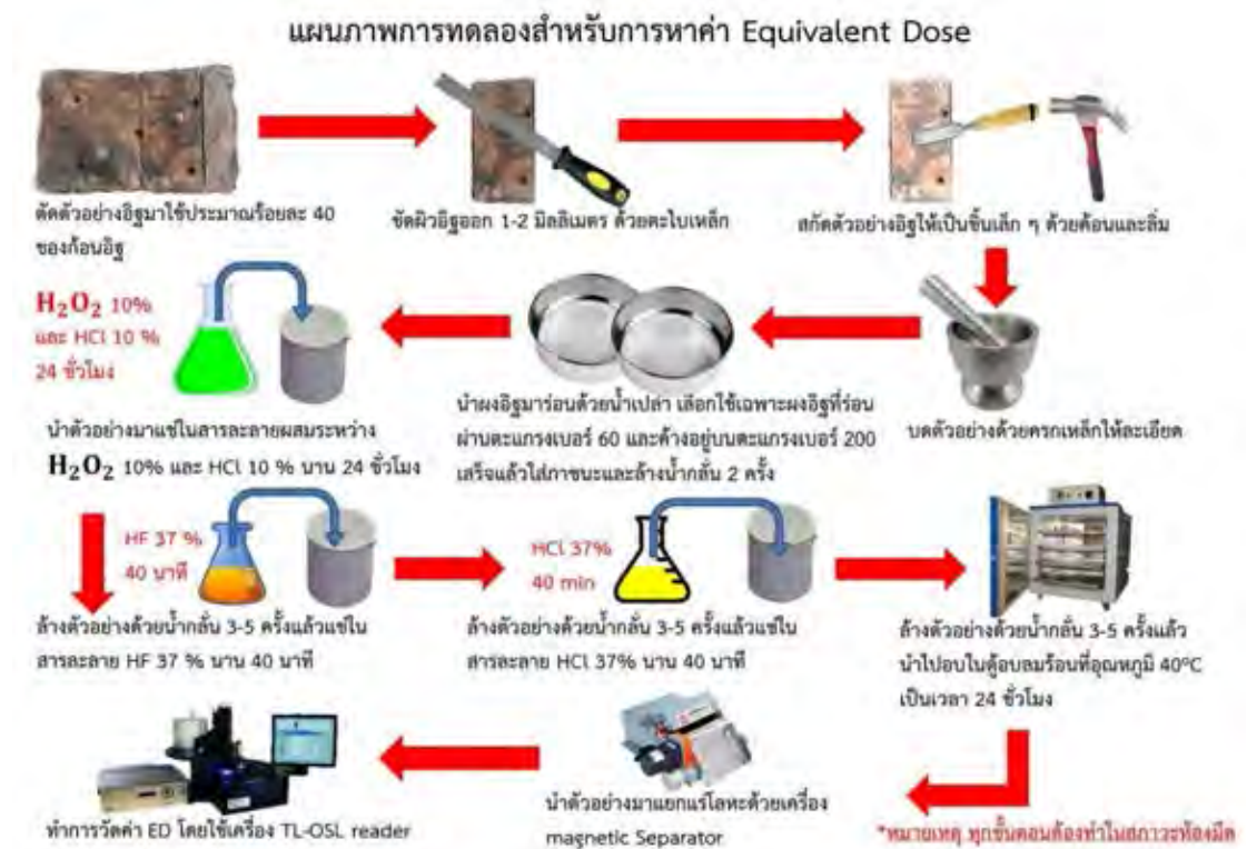
รูปที่ 18 รูปแสดงแผนภาพการทดลองสำหรับการหาค่า Equivalent Dose
