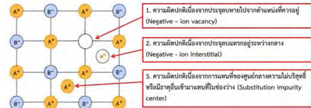
รูปที่ 7 แสดงลักษณะความผิดปกติแบบต่าง ๆ ที่สามารถเกิดขึ้นในโครงผลึกของแร่
