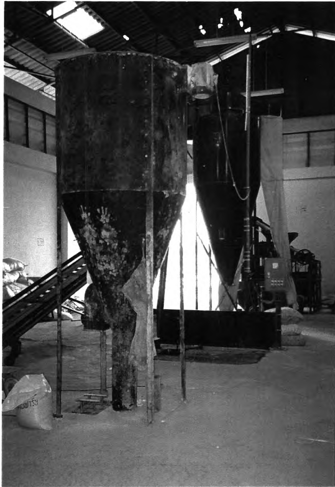
รูปที่ 38 เครื่องผสมอาหารโคนม ของโรงงาน 3
