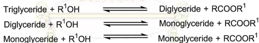
รูปที่ 2.2 สมการทั่วไปของปฏิกิริยาทรานเอสเทอร์ฟิเคชันของไตรกลีเซอไรด์
