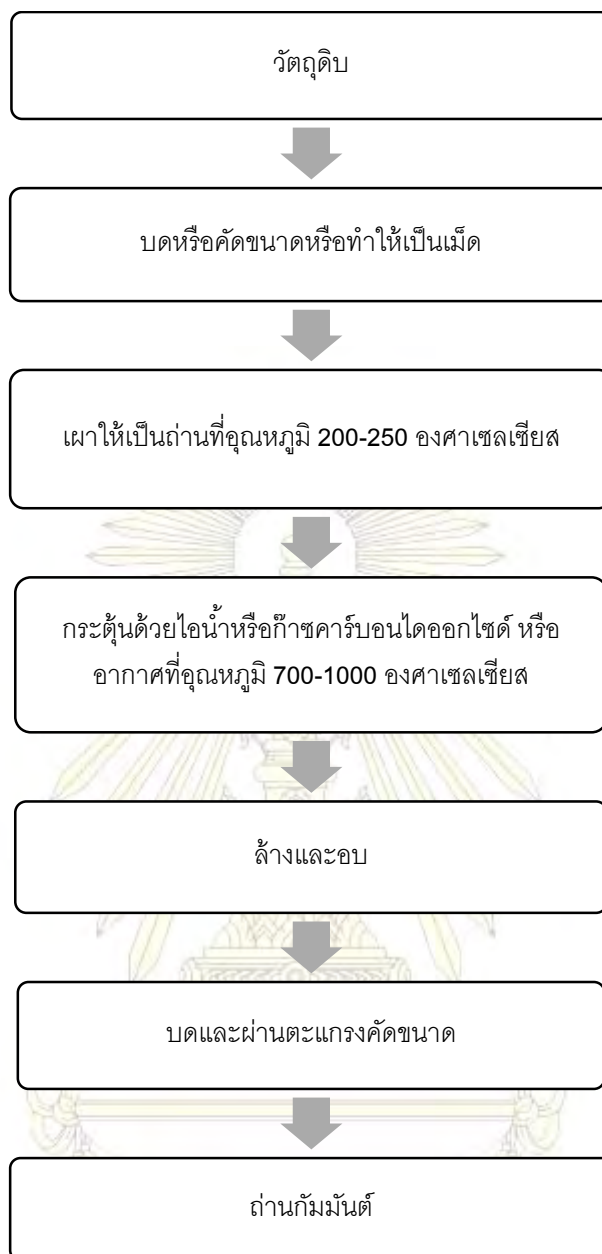
รูปที่ 2.10 ขั้นตอนการผลิตถ่านกัมมันต์ด้วยวิธีทางกายภาพ
