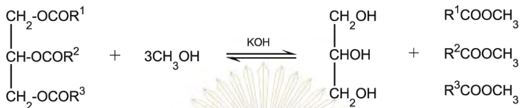
รูปที่ 2.6 ปฏิกิริยาทรานเอสเทอร์ฟิเคชันโดยใช้โพแทสเซียมไฮดรอกไซด์เป็นตัวเร่งปฏิกิริยา
