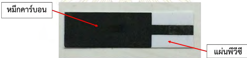
รูปที่ 3.1 (ข) ขั้วไฟฟ้าคาร์บอนพิมพ์สกรีน (Screen-printed carbon electrode, SPCE)
