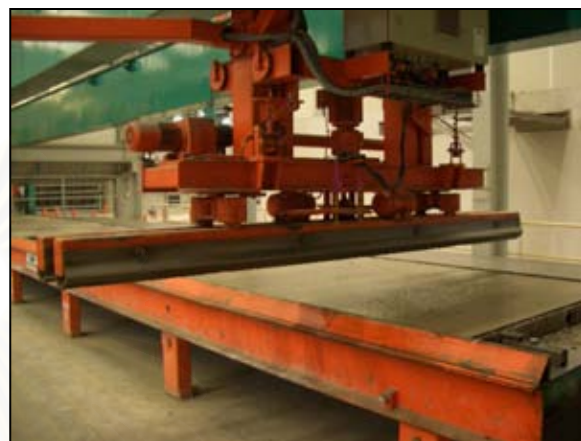
รูปที่ 5.21 แสดงรายละเอียดเครื่อง Screeding
