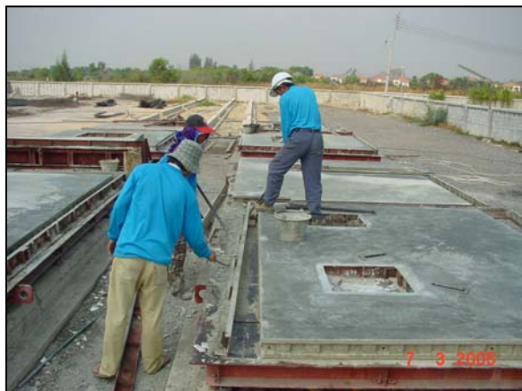
รูปที่ 5.116 แสดงขั้นตอนถอดแบบข้าง รูปที่ 5.117 แสดงการยกชิ้นงาน ที่มา : จากการสำรวจ ณ โรงงานชั่วคราวผลิตชิ้นส่วนสำเร็จรูป บริษัท ซีอตรงกรุ๊ป จำกัด รังสิตคลอง 3
