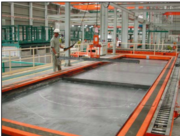
รูปที่ 5.43 แสดงขั้นตอน Shuttering Station
