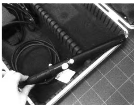
ภาพที่ 1.3 เครื่องมือวัดความเร็วลม Testo 454
