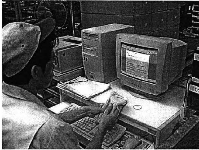
ภาพที่ 5.12 การอ่านใบคัมบังด้วยเครื่องอ่าน Bar code
