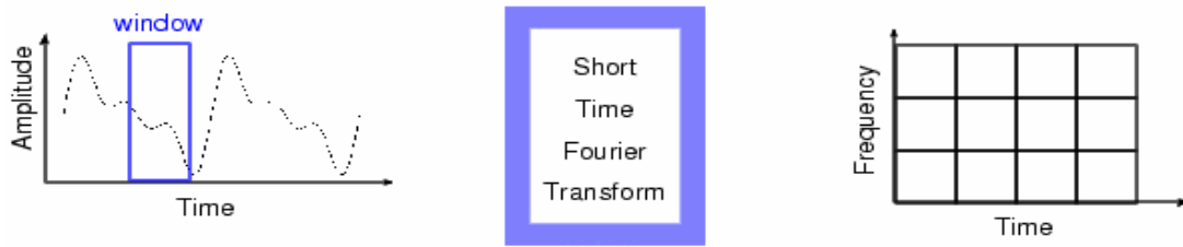
รูปที่ 2.4 การวิเคราะห์สัญญาณโดยแปลงสัญญาณแบบฟูรีเยร์ช่วงสั้น
