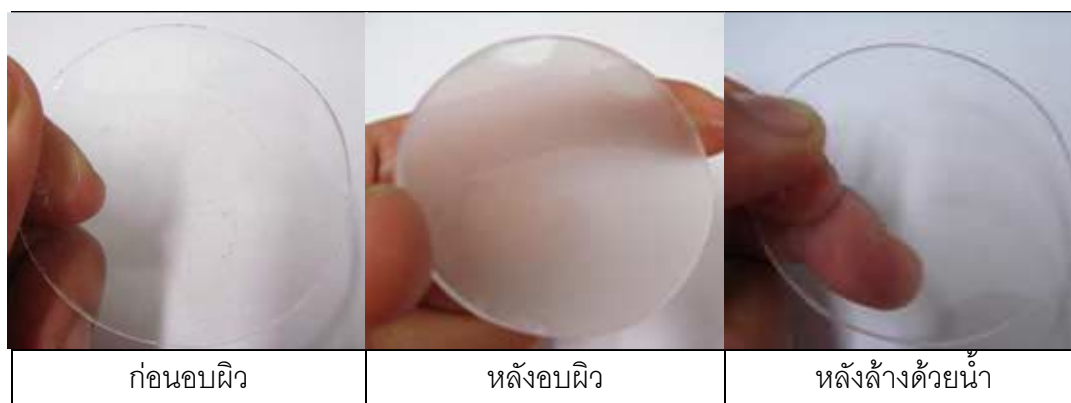
ภาพที่ 4.2 ลักษณะของผิวตัวอย่างแก้วก่อนและหลังการอบผิวและการล้างทำความสะอาด
