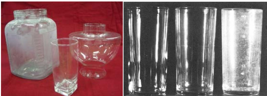
ภาพที่ 2.7 ลักษณะของตำหนิฝ้าที่เกิดบนผิวแก้ว [21]
