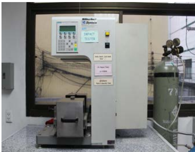
รูปที่ 3.7 เครื่องทดสอบความทนแรงกระแทกแบบ Izod ยี่ห้อ Dynisco รุ่น SIMATIC-OP7
