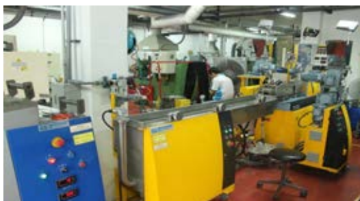
รูปที่ 3.2 เครื่องอัดรีดแบบสกรูคู่ (LabTech type LE25-30C)
