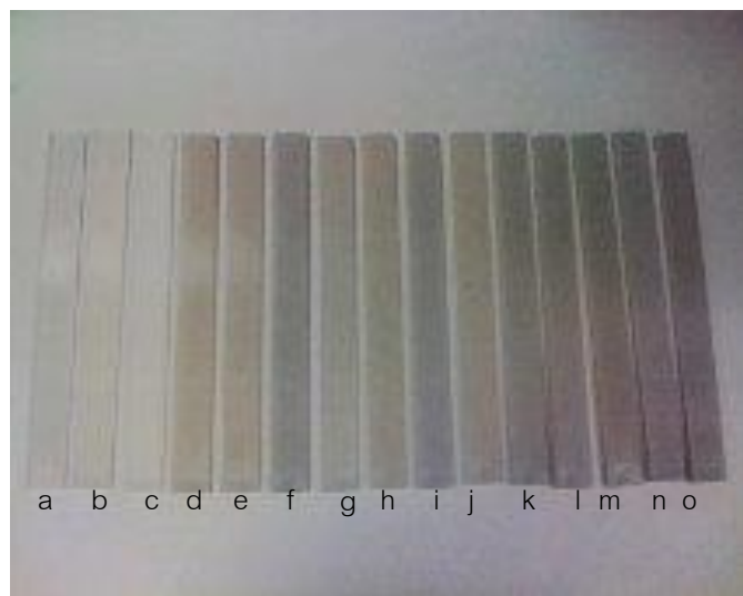
รูปที่ 4.1 ชิ้นทดสอบพอลิโพรพิลีน/ยางเอทิลีนโพรพิลีนไดอีน/โวลลาสโทไนต์คอมพอสิตทั้งที่ใส่และไม่ใส่พอลิโพรพิลีนกราฟต์มาเลอิกแอนไฮไดรด์ที่อัตราส่วน (a) 100/0/0 (b) 80/20/0 (c) 70/30/0 (d) 80/20/10 (e) 80/20/20 (f) 80/20/30 (g) 70/30/10 (h) 70/30/20 และ (i) 70/30/30 (j) 80/20/10/5 (k) 80/20/20/5 (l) 80/20/30/5 (m) 70/30/10/5 (n) 70/30/20/5 (o) 70/30/30/5
