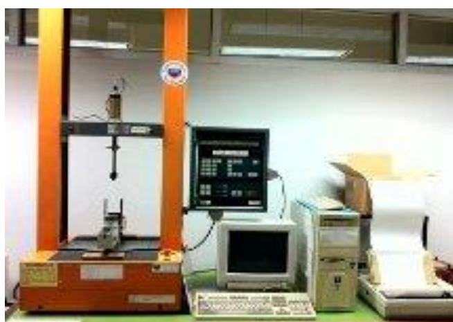
รูปที่ 3.6 เครื่องทดสอบยูนิเวอร์แซล (LLOYD 500)
