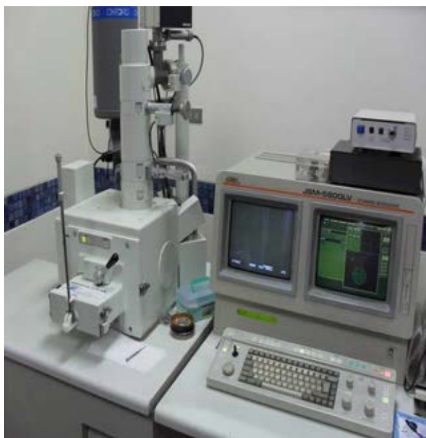
รูปที่ 3.10 กล้องจุลทรรศน์อิเล็กตรอนแบบส่องกราด (Jeol, JSM 5800 LV)
