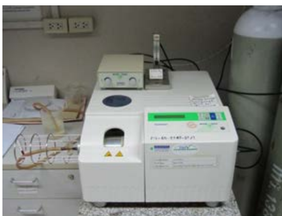
รูปที่ 3.8 เครื่องเทอร์โมกราวิเมตริกแอนาไลเซอร์ ของ Mettler-Toledo รุ่น TGA/SDTA 851 e
