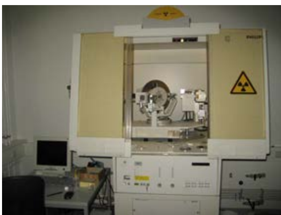
รูปที่ 3.16 เครื่องวัดการเลี้ยวเบนรังสีเอกซ์ของ Philips รุ่น PW 3710
