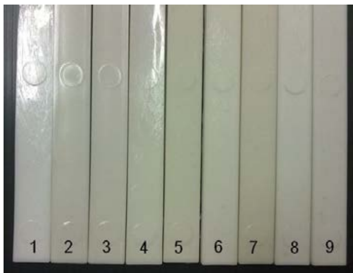
รูปที่ 4.7 ลักษณะทางกายภาพของชิ้นงานพอลิเอทิลีนเทเรฟทาเลตบริสุทธิ์และพอลิเอทิลีนเทเรฟทาเลตคอมพาวนด์
