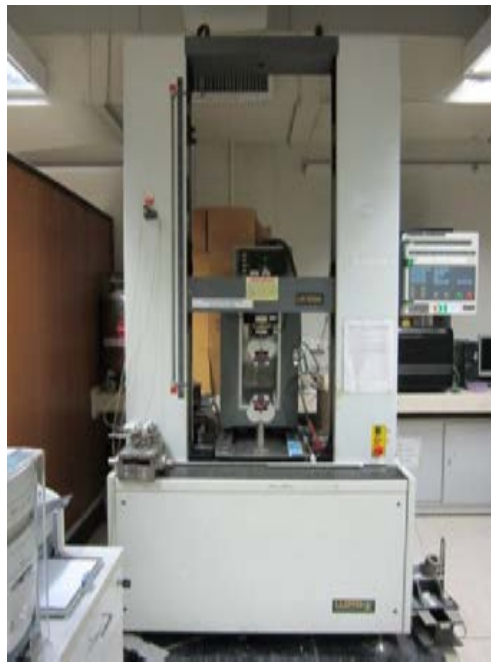
รูปที่ 3.11 เครื่องทดสอบแรงดึงประสงค์ของ Lloyd รุ่น LR 100K
