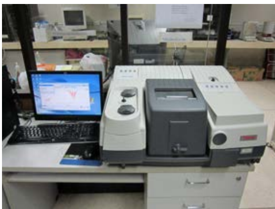
รูปที่ 3.15 เครื่องฟูเรียร์ทรานสฟอร์มอินฟราเรดสเปกโทรสโกปี (FT-IR) ของ Thermo Nicolet รุ่น NICOLET 6700
