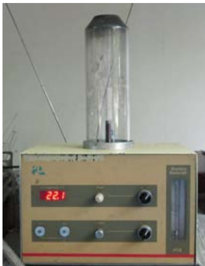
รูปที่ 3.6 เครื่องวิเคราะห์หัดชันีออกซิเจนจำกัดของ Stanton Redcroft รุ่น FTA
