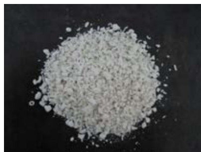
รูป ก-6 พอลิเอทิลีนเทเรฟทาเลตคอมพาวนด์ ที่ผสมทัลก์
