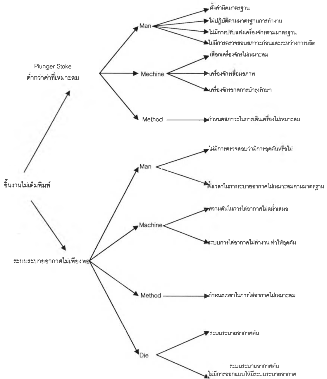
รูปที่ ง-4 ( ต่อ ) แผนภาพต้นไม้แสดงสาเหตุของปัญหาชิ้นงานไม่เต็มพิมพ์
