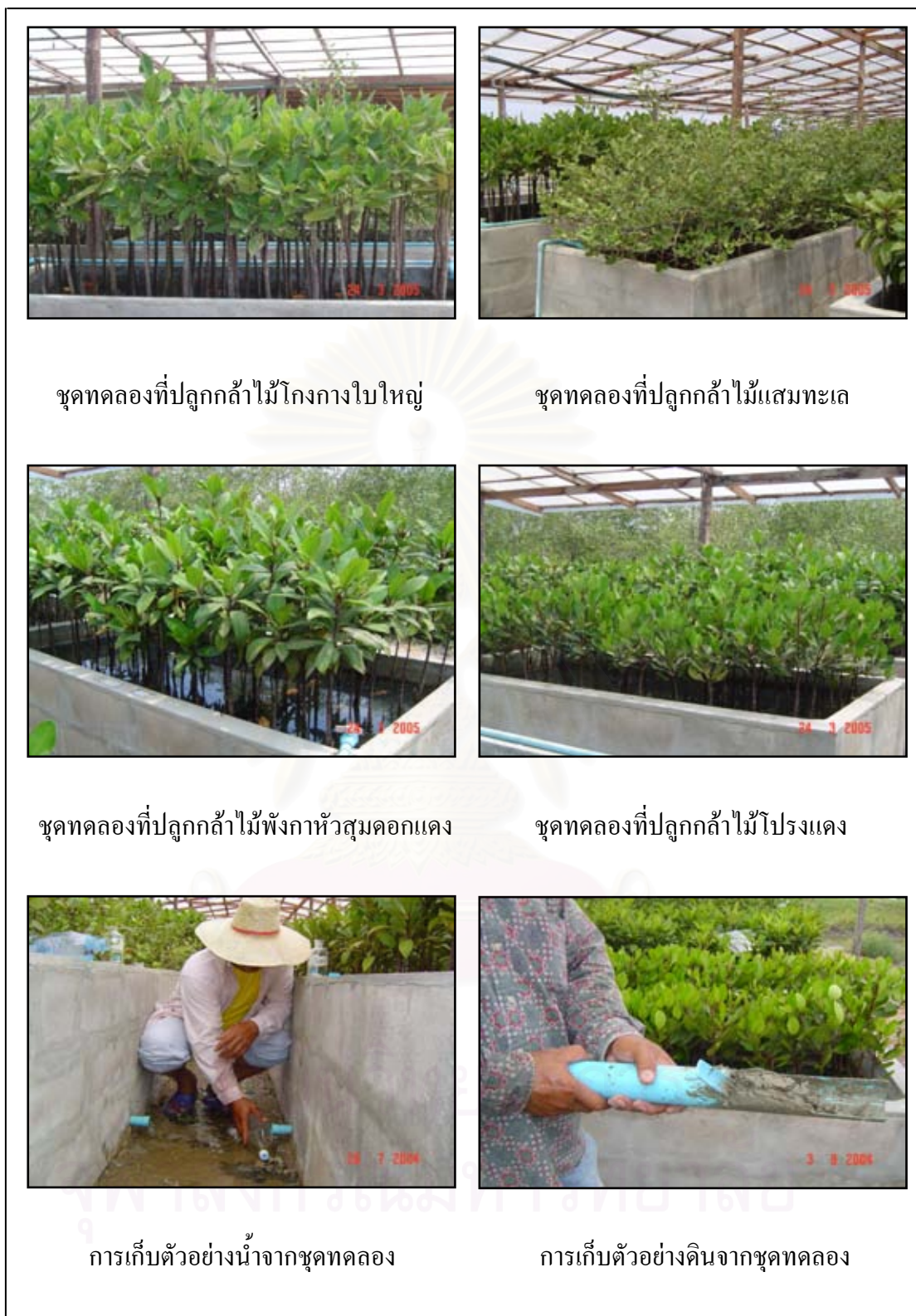
รูปที่ ง.2 ชุดทดลองพื้นที่ชุ่มน้ำเทียม ณ. พื้นที่โครงการศึกษาวิจัยและพัฒนาสิ่งแวดล้อมภาคลุ่มแหลมฝักเบ็ยอันเนื่องมาจากพระราชดำริ เมื่อสิ้นสุดการทดลอง รวมทั้งการเก็บตัวอย่างน้ำและดิน
