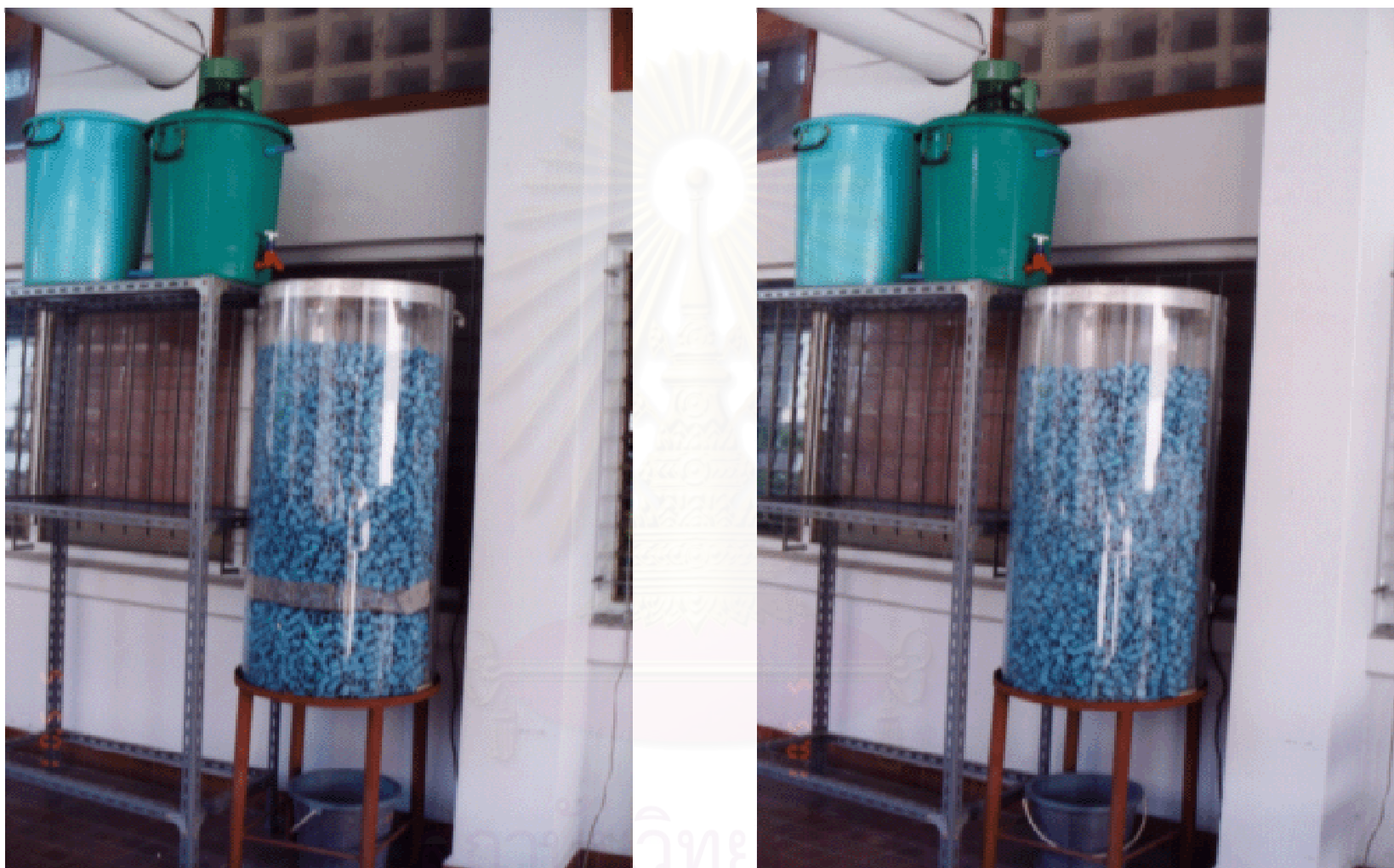
รูปที่ 3.3 ระบบไปรยกรองศึกษา ระบบร่วมเยื่อแผ่น-ถังไปรยกรอง (ซ้่าย) ระบบไปรยกรองธรรมดา (ขวา)
