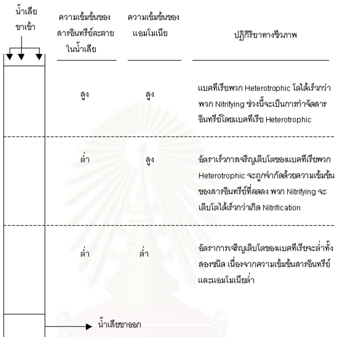
รูปที่ 2.3 การทำงานของแบคทีเรียที่มีความลึกต่างๆของถังโปรยกรอง [10]
