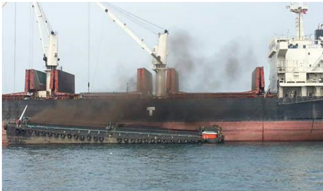
ภาพที่ 4 การฟุ้งกระจายของสินค้าถ่านหินขณะขนถ่าย ที่มา : มติชนออนไลน์, (2562)
