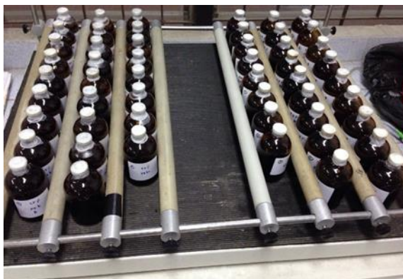
ภาพที่ 25 ชุดการทดลองบีเอ็มพีในการศึกษาปริมาณก๊าซชีวภาพ
