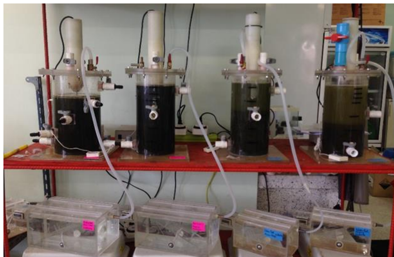
ภาพที่ 27 ชุดการทดลองในถังปฏิกรณ์กวนสมบูรณ์แบบแบตช์สำหรับการศึกษาประสิทธิภาพการผลิตก๊าซชีวภาพโดยการหมักร่วม (co-digestion)
