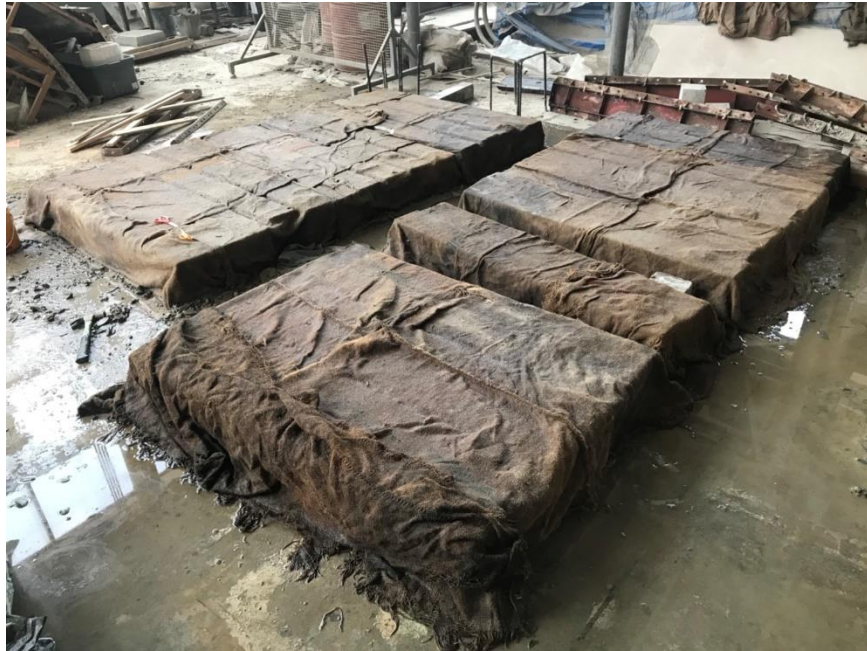
(ค) การบ่มตัวอย่างด้วยกระสอบป่านอิมตัวด้วยน้ำตลอดเวลา
