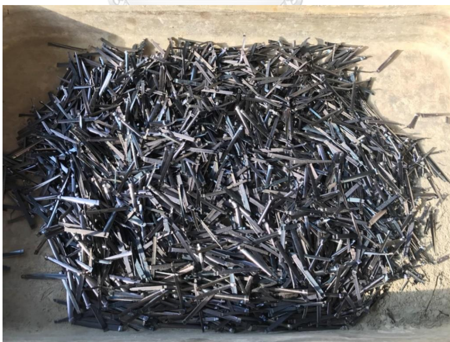
รูปที่ 29 ลักษณะของเส้นใยเหล็กที่ใช้
