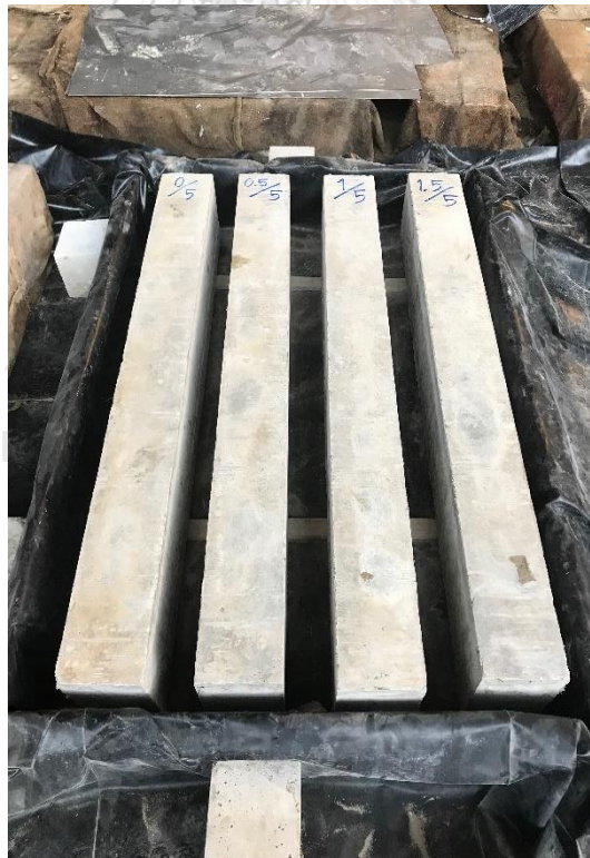
(ง) การเตรียมคานเพื่อเข้าสู่กระบวนการกัดกร่อน รูปที่ 31 การเตรียมตัวอย่างคานทดสอบ
