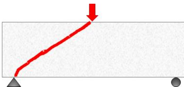
รูปที่ 9 ลักษณะการวิบัติโดยแรงเฉือนเนื่องจากแรงเฉือนโดยตรง (Splitting Shear Failure)
