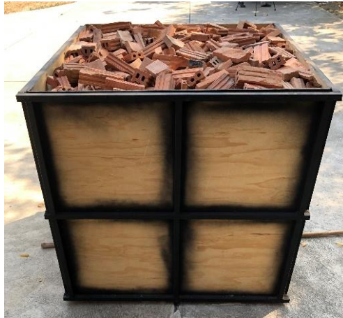
รูปที่ 4.20 ของเสี้ยนที่นำไปใส่ในกล่องลูกบาศก์ปริมาตร 1 ลูกบาศก์เมตร จนเต็มถึง
