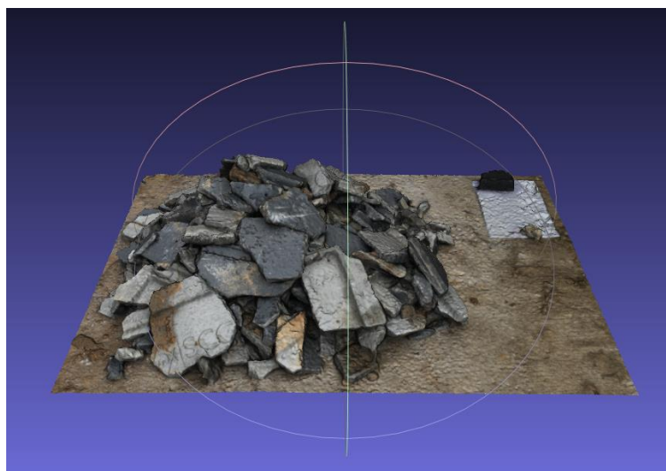
รูปที่ 4.31 โมเดล 3 มิติ ของกองเสี้ยวจากโครงการก่อสร้าง
