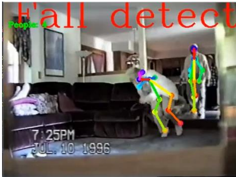
รูปที่ 53 ผลการทดสอบระบบกับวิดีโอผู้สูงอายุที่เกิดเหตุการณ์หกล้ม
