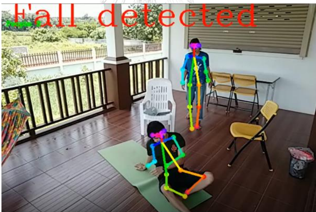
รูปที่ 49 ผลการทดสอบระบบตรวจจับการหกล้ม
