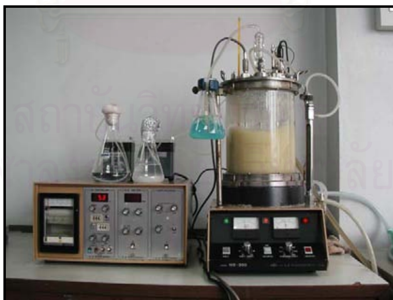
รูปที่ 4.7 การผลิตกรดมะนาวด้วยยีสต์ตรึงในถังหมักขนาด 5 ลิตร
