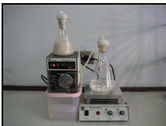
รูปที่ 4.5 การเตรียมเซลล์ตรึงโดยวิธีกักขังบนแคลเซียมอัลจิเนต
