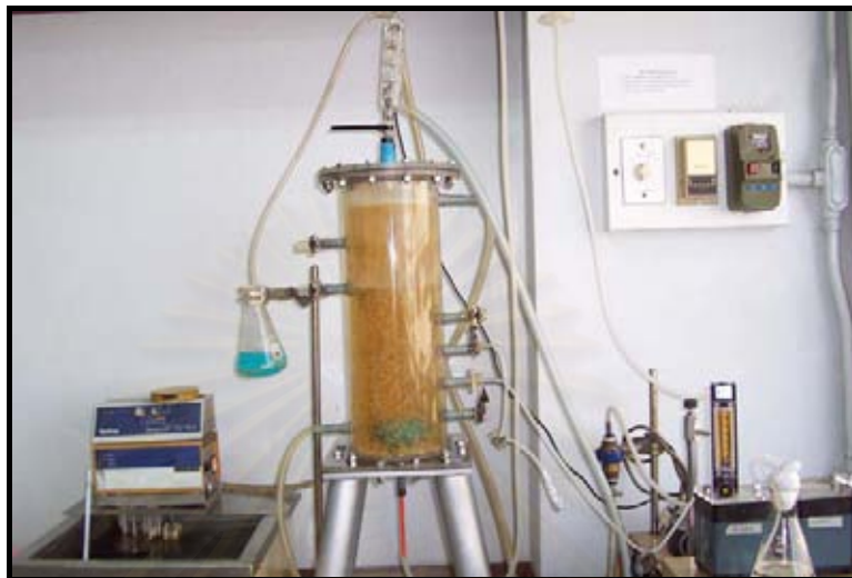
รูปที่ 4.12 การตรึงเซลล์ C. oleophila NNU-62 เพื่อผลิตกรดมะนาวในถังหมักแบบฟลูอิดไดซ์เบด
