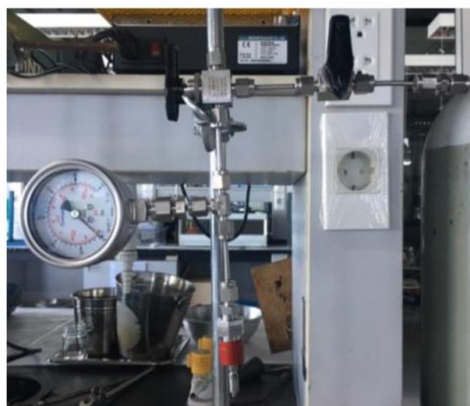
รูปที่ 3.12 เครื่องปฏิกรณ์อโตเคลฟที่อัดความดัน (ซ้าย) และชุดอุปกรณ์อัดความดัน (ขวา)
