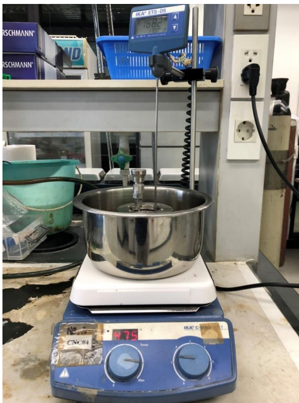
รูปที่ 3.13 ระบบเครื่องปฏิกรณ์สำหรับการเปลี่ยนกลูโคสเป็น HMF
