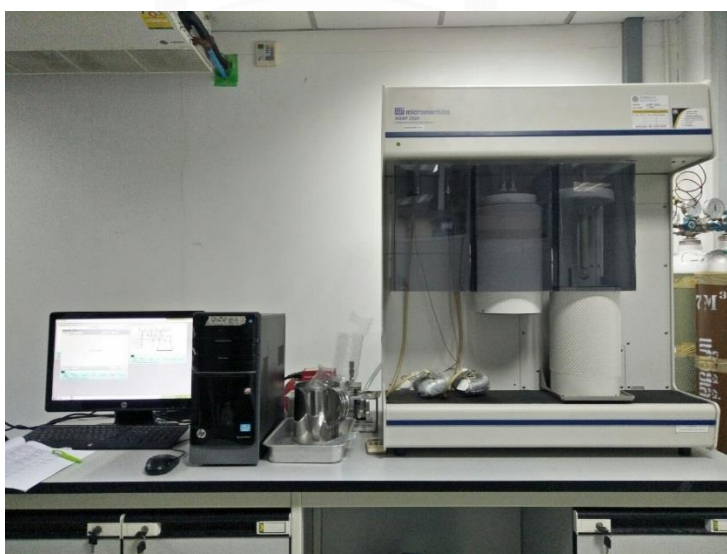
รูปที่ 3.3 เครื่องวัดพื้นที่ผิวและความเป็นรูพรุนด้วยเทคนิคการวัดการดูดซับไนโตรเจน
