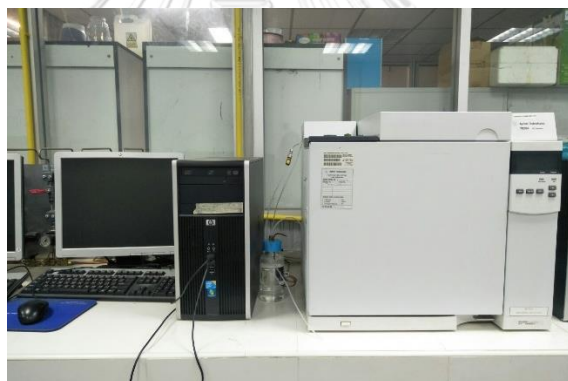
รูปที่ 3.12 เครื่องแก๊สโครมาโทกราฟี ตัวตรวจวัดชนิด flame ionization (GC-FID)
