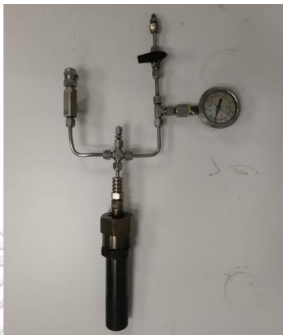
รูปที่ 3.4 เครื่องปฏิกรณ์แบบแบตช์ ขนาด 70 มิลลิตร
