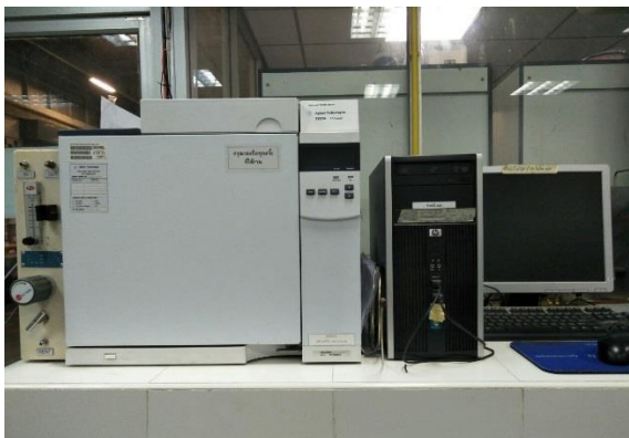
รูปที่ 3.11 เครื่องแก๊สโครมาโทกราฟี ตัวตรวจวัดชนิด thermal conductivity (GC-TCD)
