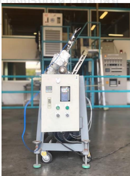
รูปที่ 3.5 เครื่องปฏิกรณ์ที่ติดตั้งอยู่กับเครื่องแกว่งปฏิกรณ์ขนาดเล็กและเครื่องควบคุมความร้อน
