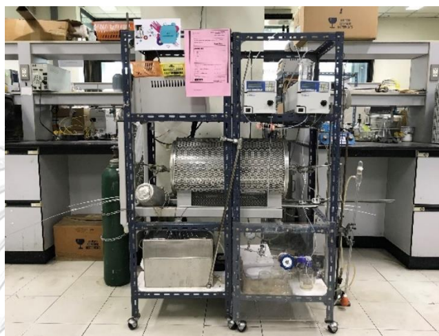
รูปที่ 3.3 เครื่องปฏิกรณ์แบบกึ่งต่อเนื่อง
